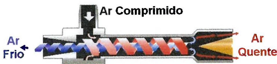
Fig. 1 - Esquema de funcionamento de um Tubo de Vórtices
