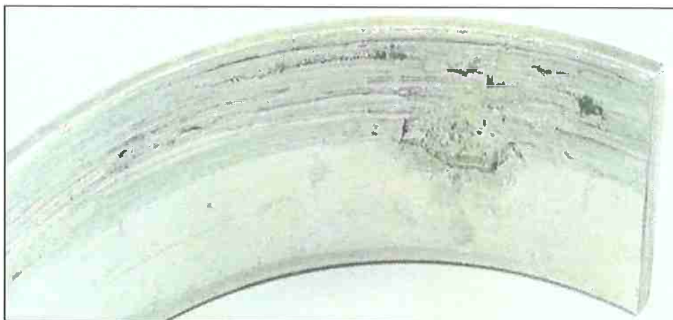
Figura 4: Exemplo de engripamento em uma bronzina bimetálica.
