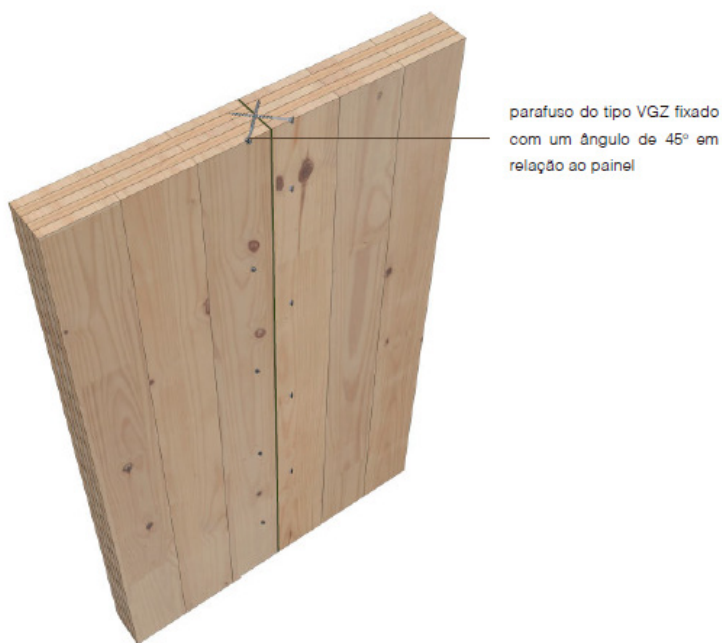
Conexão entre duas paredes de CLT alinhadas. Fonte: Crosslam, 2021
