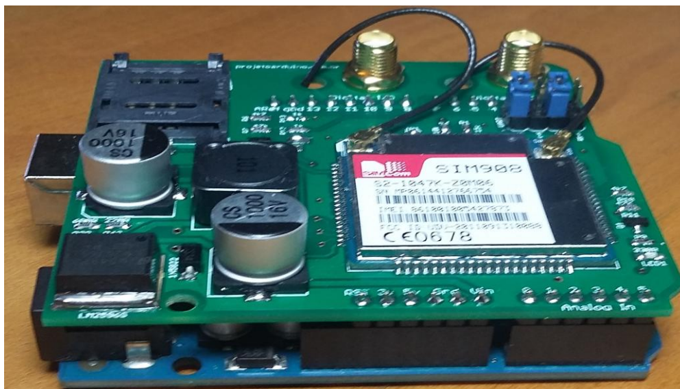
Figura 14 - Conexão do Shield com o Arduino Uno
