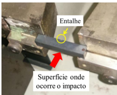
Figura 27 - Fixação do corpo de prova no ensaio de impacto Charpy
