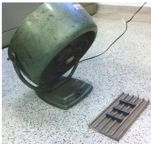
Figura 22 - Resfriamento sob ar forçado após tratamento de revenido
