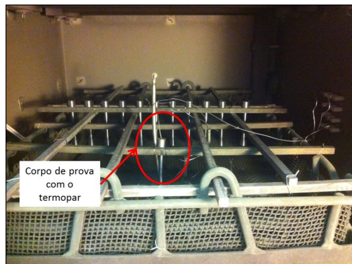
Figura 24 - Fixação dos corpos de prova no interior do forno a vácuo
