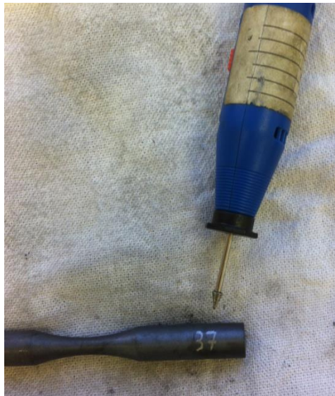
Figura 19 - Marcação dos corpos de prova utilizando uma caneta elétrica
