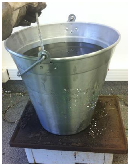
Figura 20 - Aquecimento e preparação do óleo de têmpera
