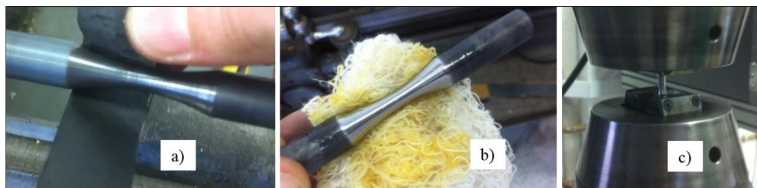
Figura 29 - Principais etapas do ensaio de fadiga: a) lixar área útil do corpo de prova; b) proteger o corpo de prova contra oxidação; c) máquina de ensaio de fadiga
