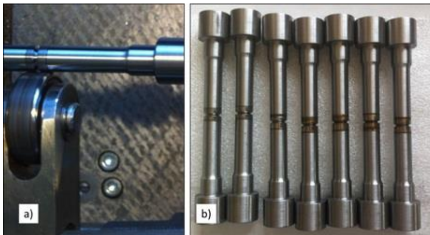
Figura 32 - a) recartilha tocando o corpo de prova; b) corpos de prova marcados após a confecção das pré trincas
