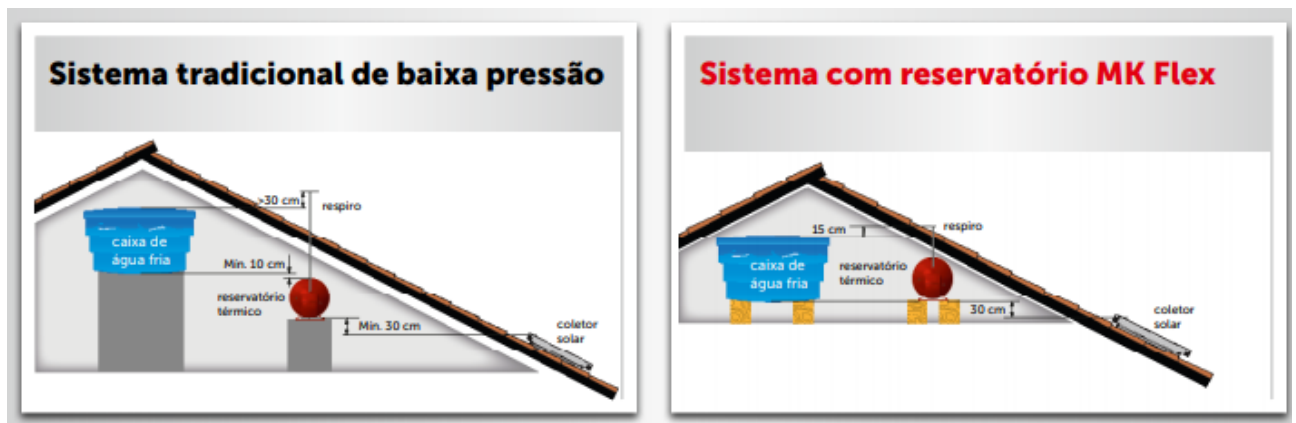
Figura 3.6 - Diferença de instalação entre sistemas
