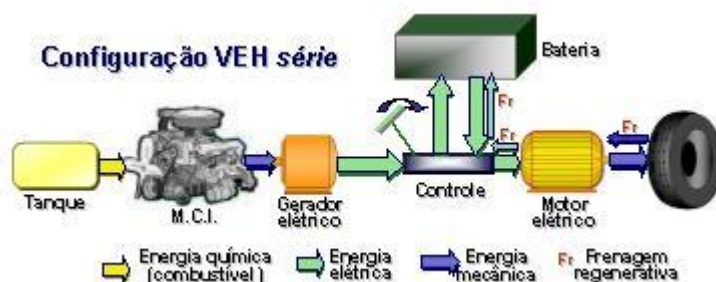
Figura 4.2: Diagrama de funcionamento de um veículo elétrico híbrido na configuração em série
