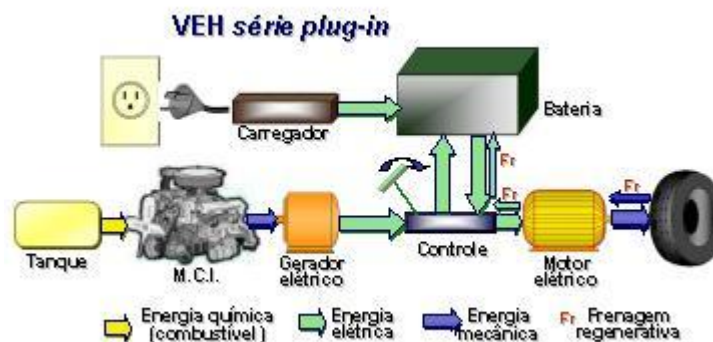
Figura 4.4: Diagrama de funcionamento de um veículo elétrico híbrido plug-in na configuração em série
