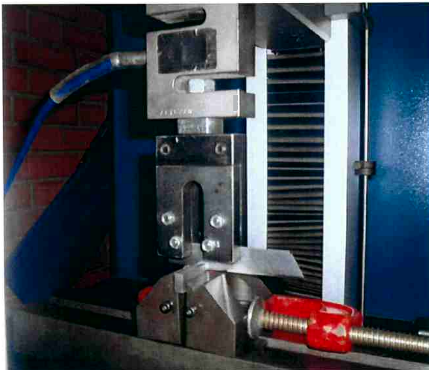
Figura 9 - Método inserção da pré-trinca de forma controlada através do dispositivo na amostra de dobramento de três pontos, material PMMA
