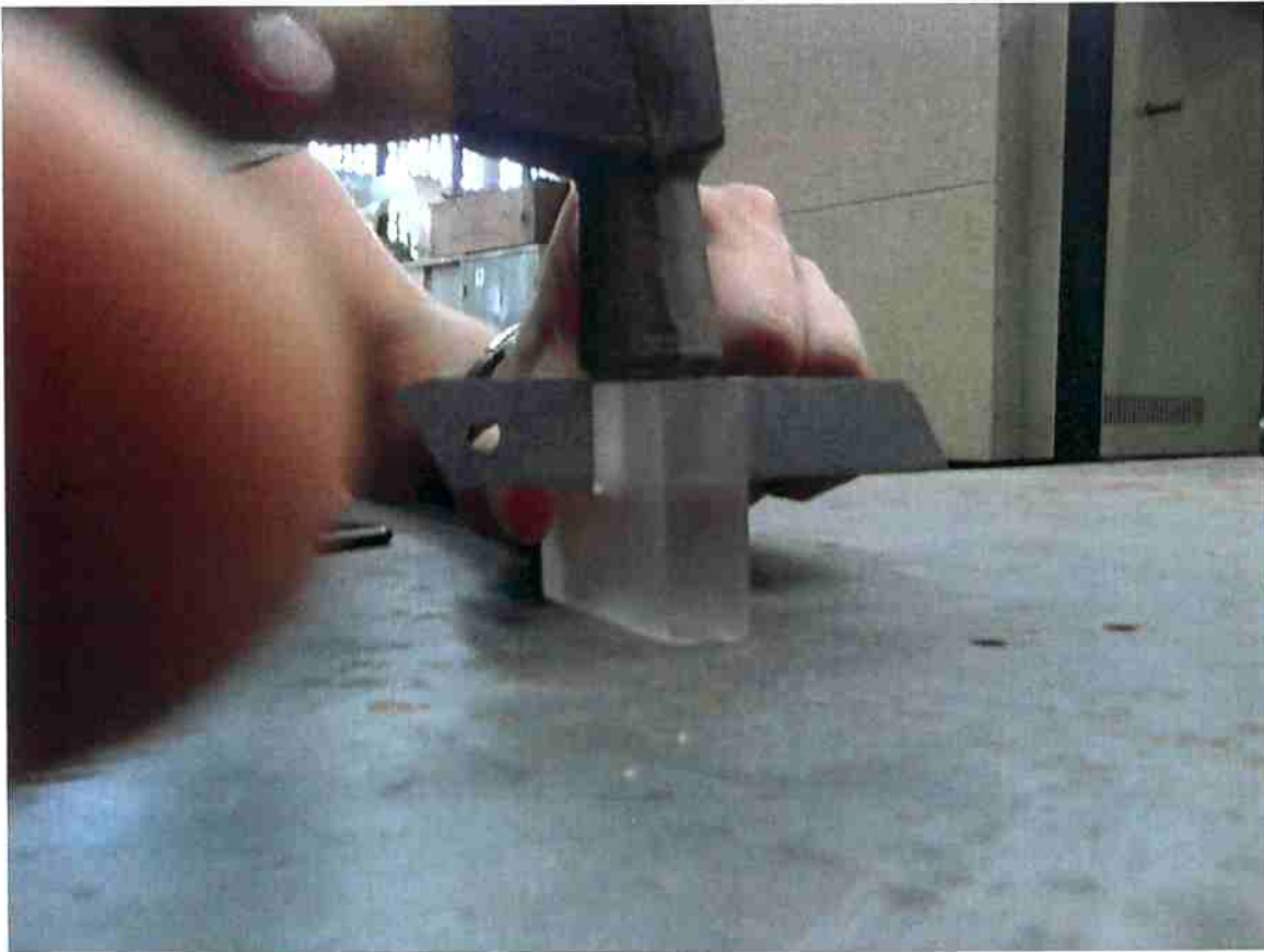
Figura 8 - Inserção de trincas "naturais" pelo método manual
