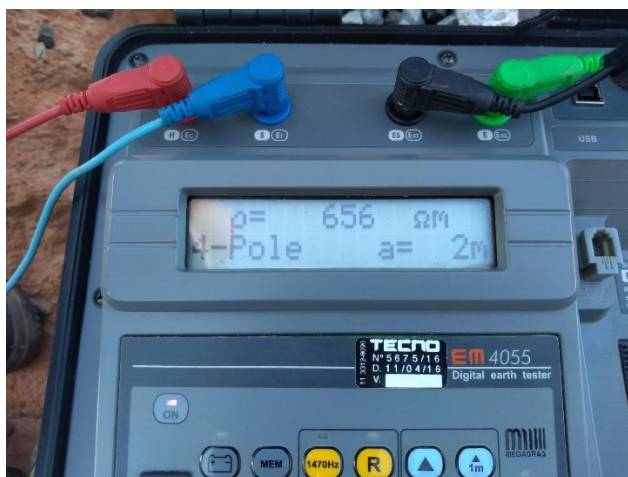
Figura 41 – Medição de Resistividade do solo
