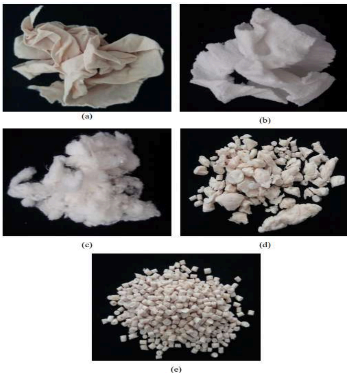
Figura 2 – Estágios da formação de retalhos de poliamida em chips de poliamida
