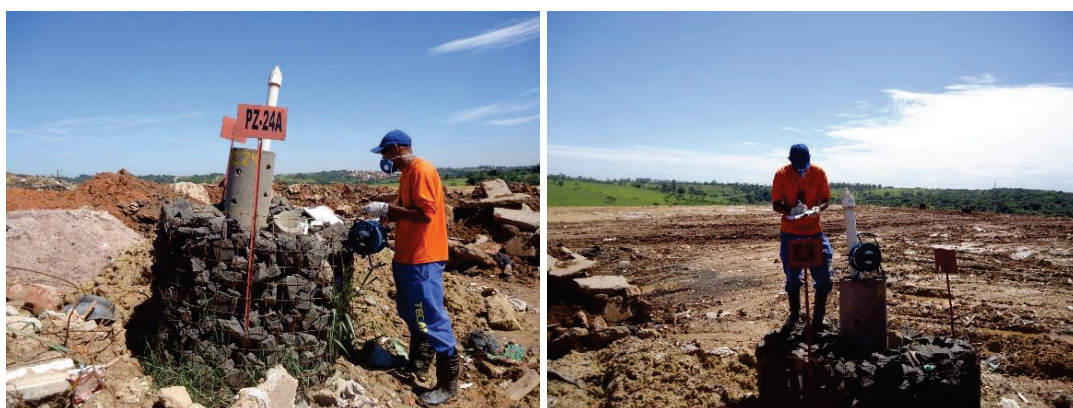
Figura 4 - Leitura dos piezômetros para monitoramento geotécnico do aterro sanitário Delta A, Campinas - SP (TECAM, 2013).
