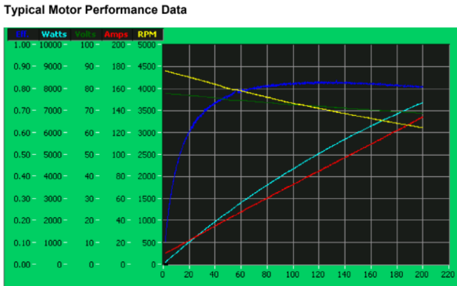
Figura 17 – Datasheet do mapa de performance do ME0913 em função do torque.
