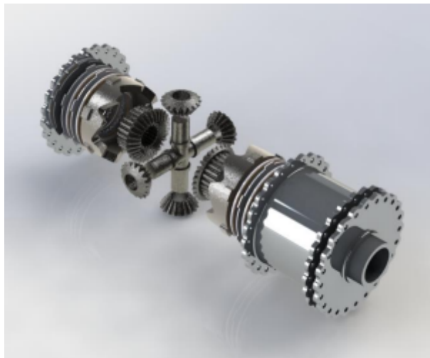
Figura 14 – Vista explodida de um diferencial mecânico projetado para competição de Fórmula SAE.
