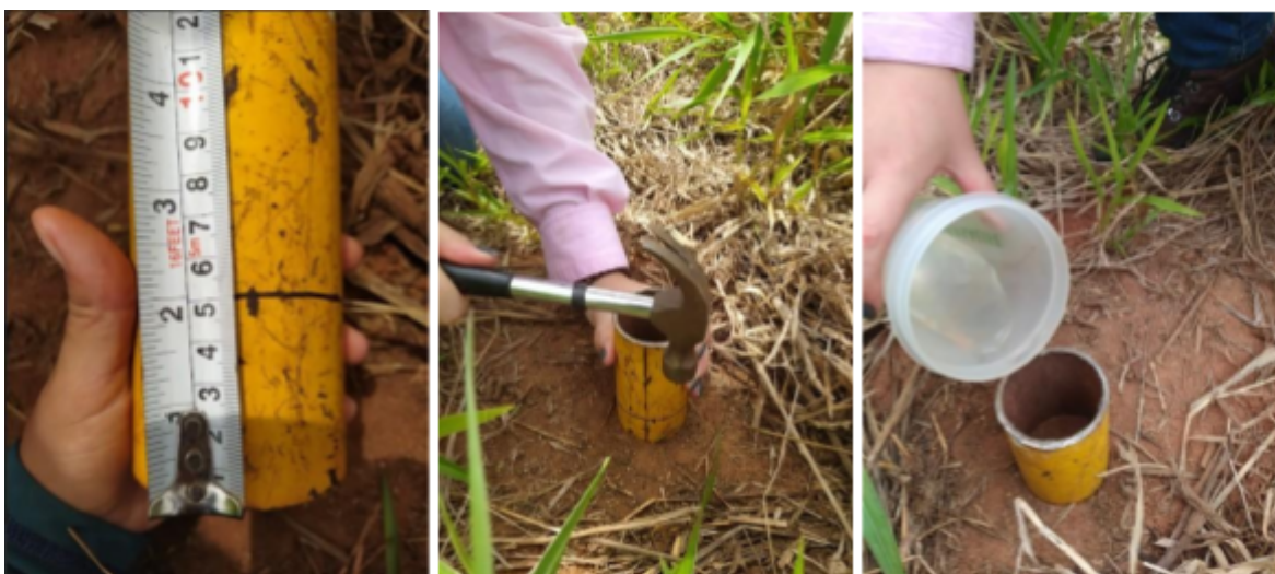
Figura 4: Coleta de dados da infiltração de água no solo: marcação de 5 cm do cilindro, inserção do cilindro no solo com auxílio de um martelo, despejo de 100 ml de água (início da contagem do cronômetro). Fonte: Autor, 2024.
