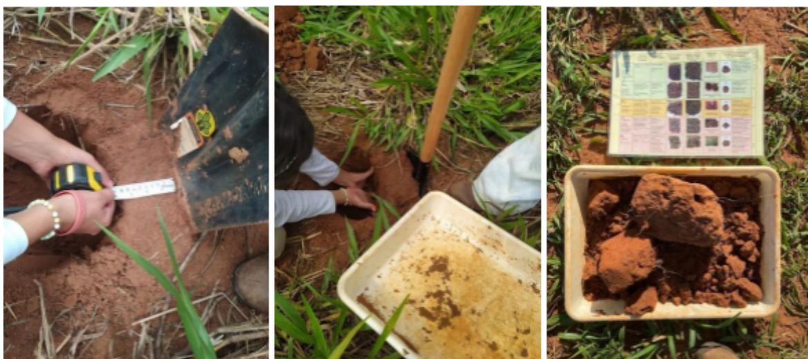
Figura 5: Coleta de dados da densidade do solo: medição de 10 cm de largura da camada a ser coletada; camada sendo retirada do solo e colocada na bandeja para análise; análise em campo seguindo o padrão da cartilha VESS. Fonte: Autor, 2024.
