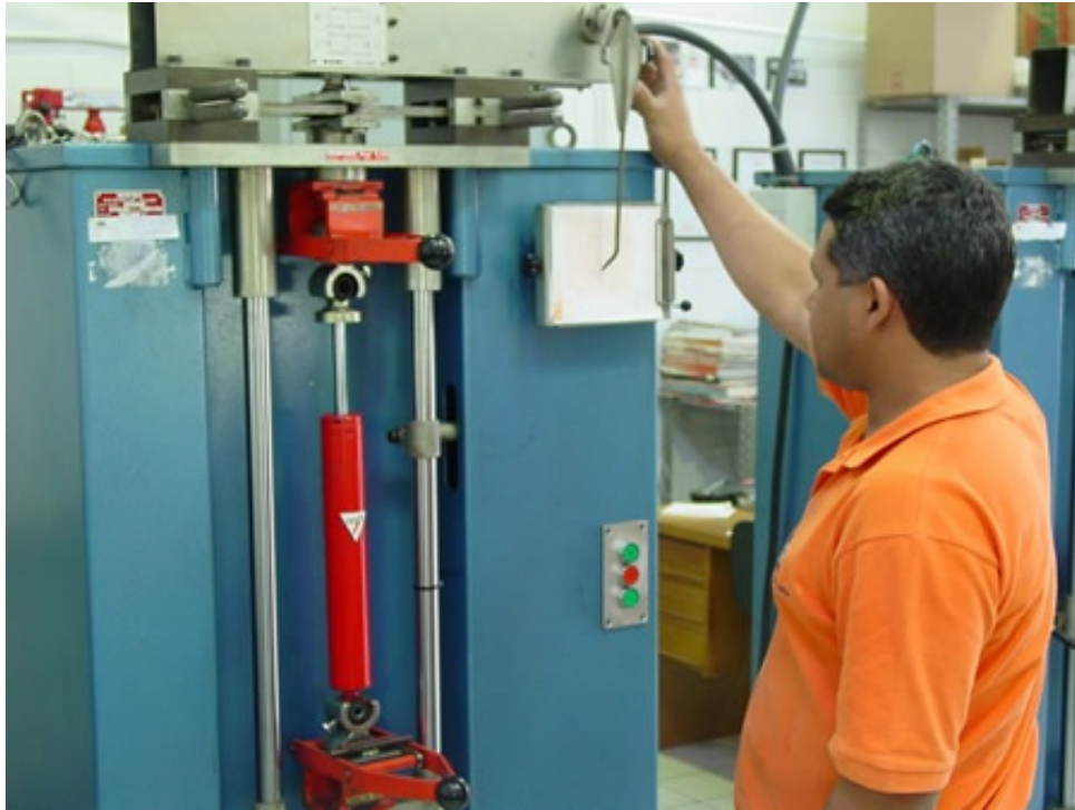
Figura 41 – Dinamômetro de amortecedores da empresa byLG Shock Absorber Tech Center (o amortecedor na imagem não corresponde ao aqui modelado)
