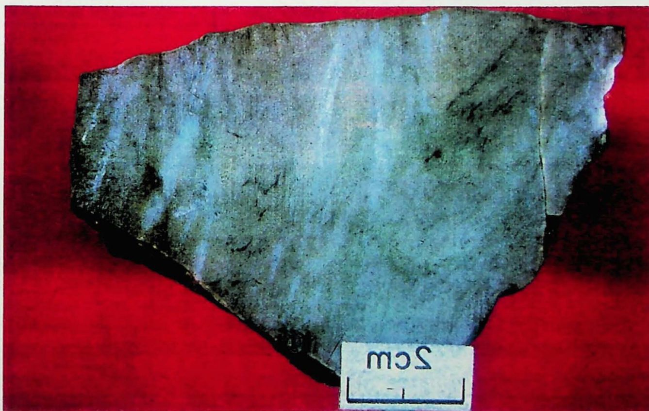
Fotografia 8: Amostra 21A - Horizonte São Bento: Bif fácies carbonato homogêneo com veios de quartzo estirados paralelos e oblíquos ao bandamento.
