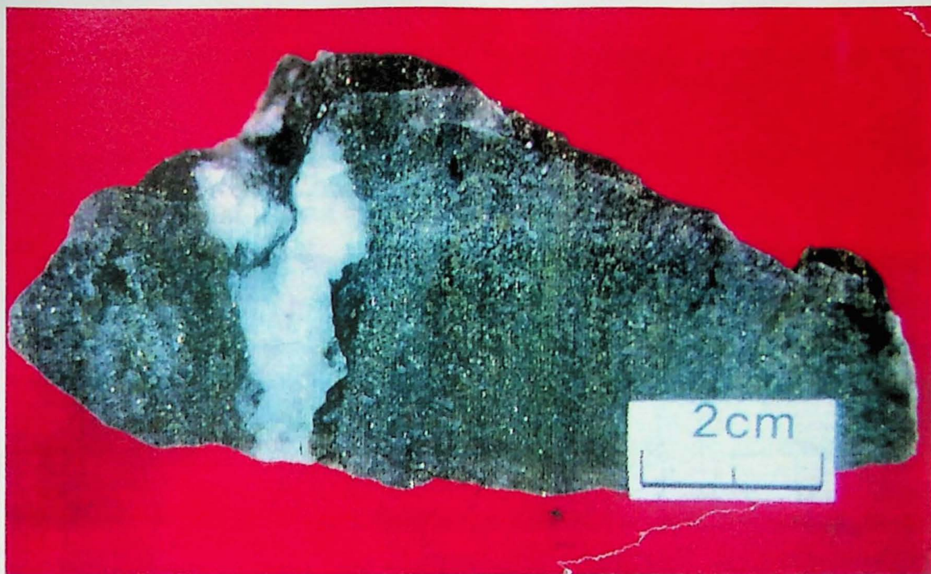
Fotografia 5: Amostra SB-10 - Horizonte Oeste: Bif fácies sulfetada maciço apresentando bandamento paralelo a sub-paralelo. Os sulfetos principais são arsenopirita, pirita e pirrotita. Apresenta veio de quartzo ondulado sub-paralelo ao bandamento com níveis de clorita nas bordas.
