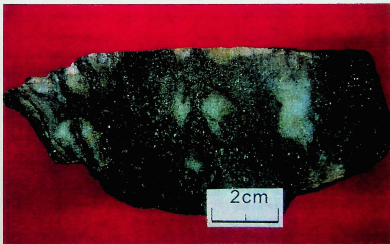
Fotografia 4: Amostra SB-09 - Horizonte Oeste: Bif fácies sulfetada maciço apresentando bandamento paralelo a sub-paralelo. Os sulfetos principais são pirita, arsenopirita e pirrotita. Ocorrem leitos cloríticos ondulados com sulfetos nas bordas. (Horizonte Oeste)
