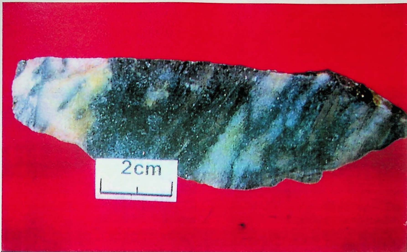
Fotografia 9: Amostra SB-28B - Horizonte Leste: Bif fácies mista sulfeto e carbonato com bandamento plano-paralelo apresentando veios de quartzo irregulares e ondulados.
