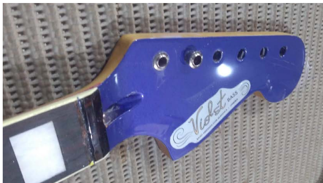
Imagens 170 e 171: fotografia de instrumento depois de pintado e início da instalação das ferragens
