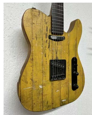
Figura 76: Guitarra Telemaster, com corpo em freijó, braço em tauari, escala imbuia de demolição e acabamento com óleo mineral
