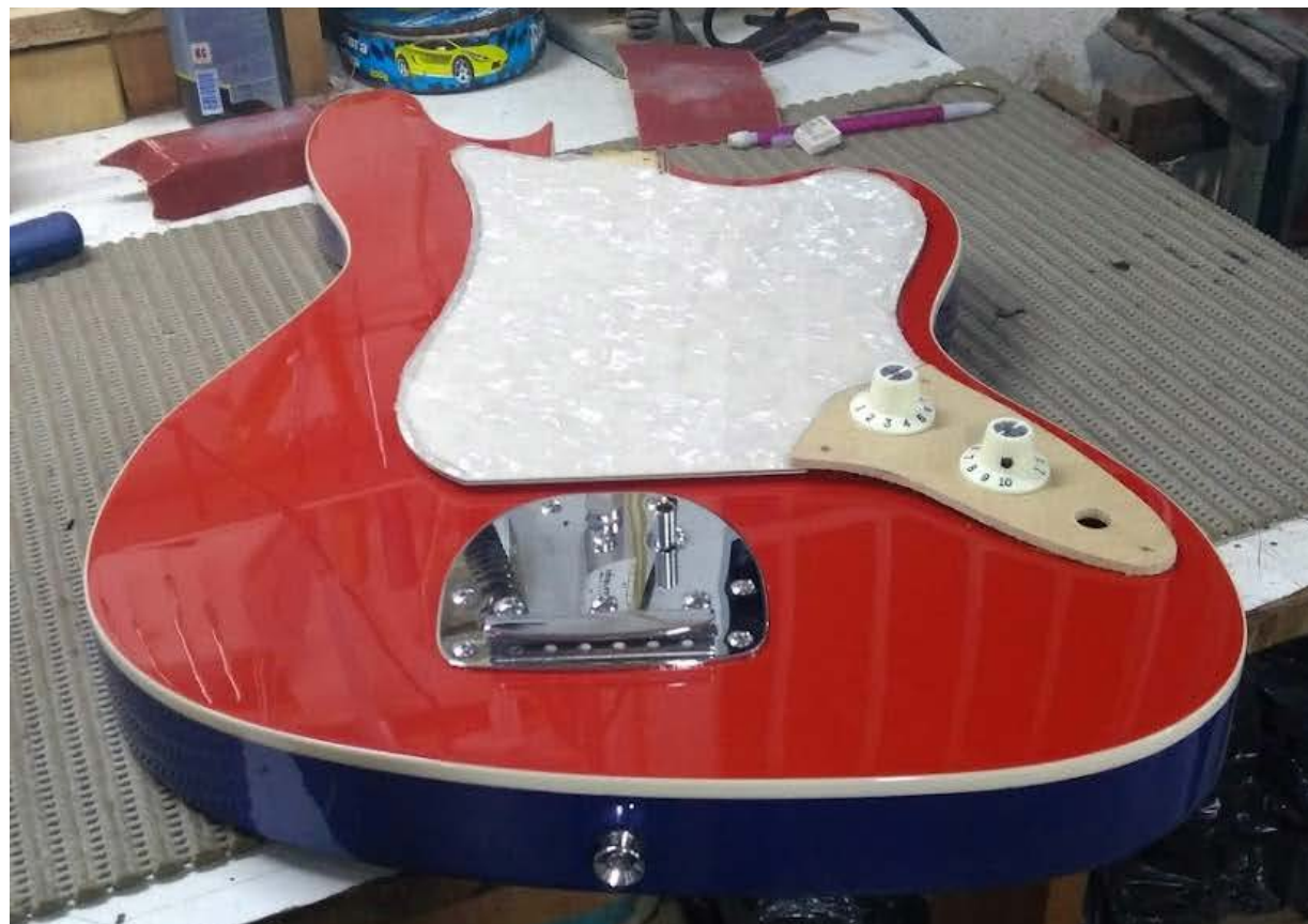
Figura 175: verificação do desenho cortado do escudo no corpo do instrumento
