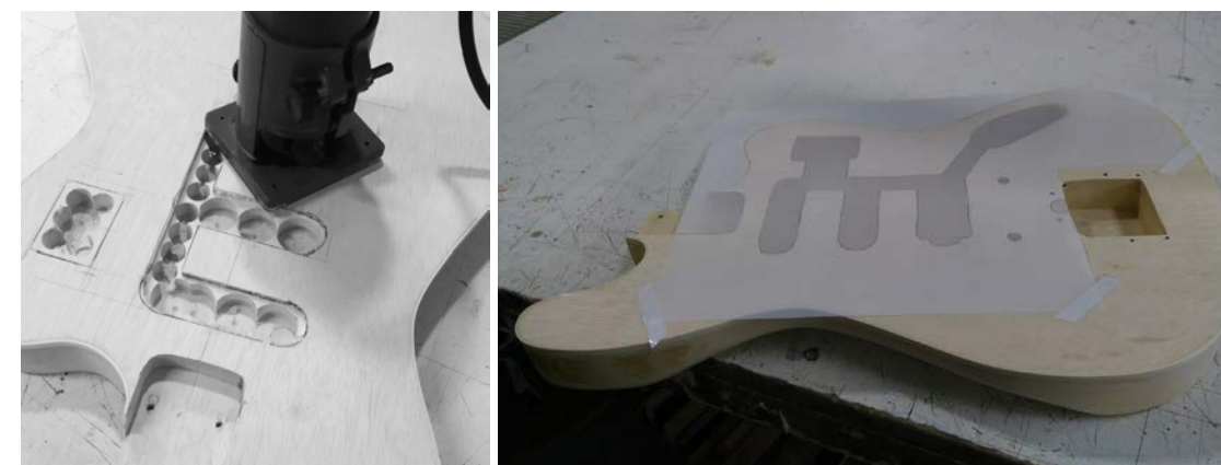
Figuras 167, 168 e 169: furação das cavidades para eletrônicos e cópia de gabarito para escudo
