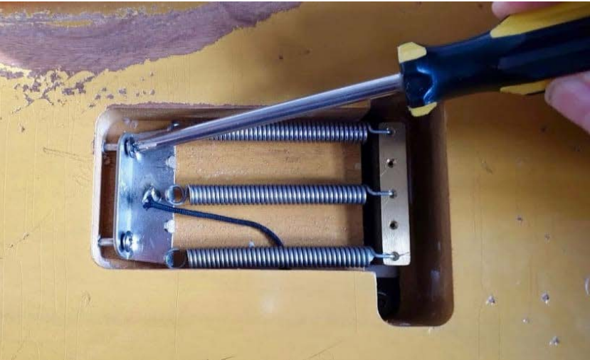
Figura 98: Fotografia do sistema de molas da guitarra Stratocaster, que é regulado nas costas do instrumento.
