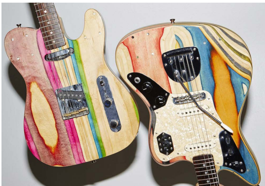
Figura 73: Pranchas inteiras usadas no corpo do instrumento, resultando em manchas coloridas.
