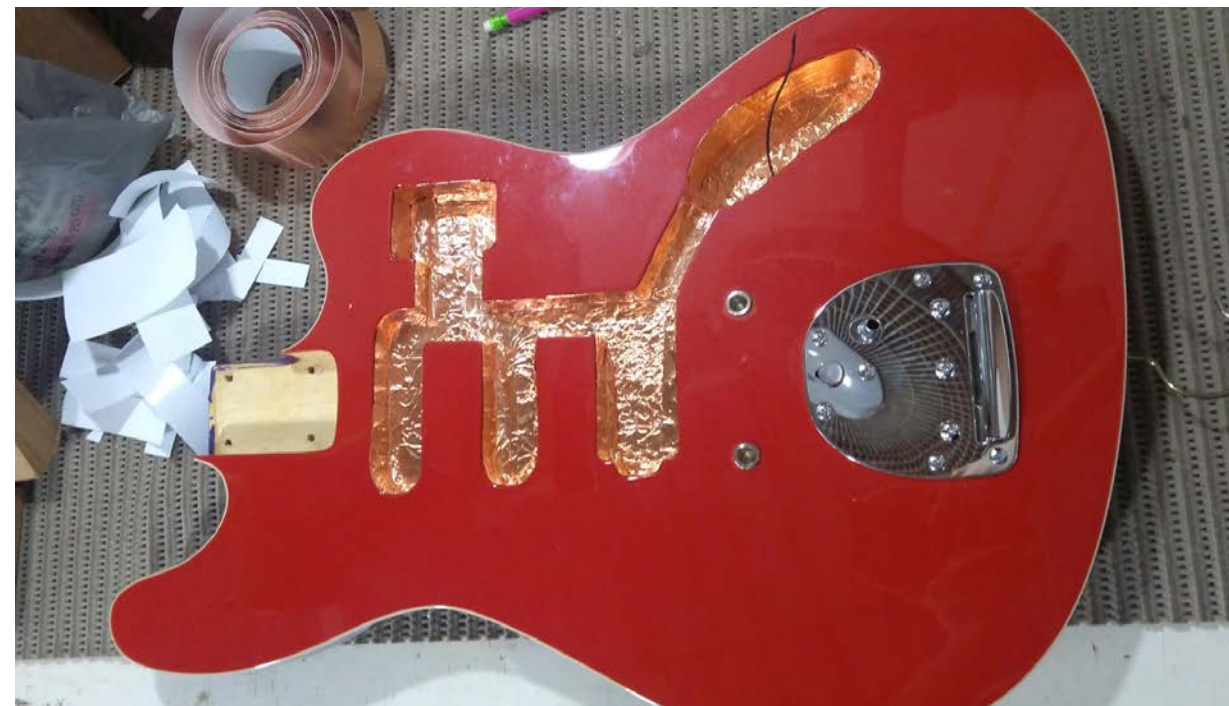
Figura 172: blindagem das cavidades com fita auto-adesiva de cobre
