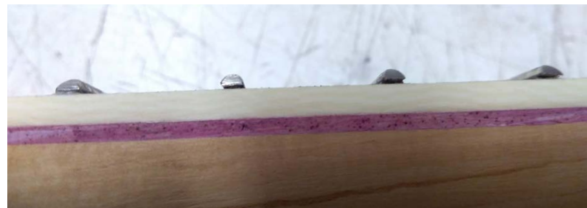
Figura 185: detalhe de trastes levantados no braço
