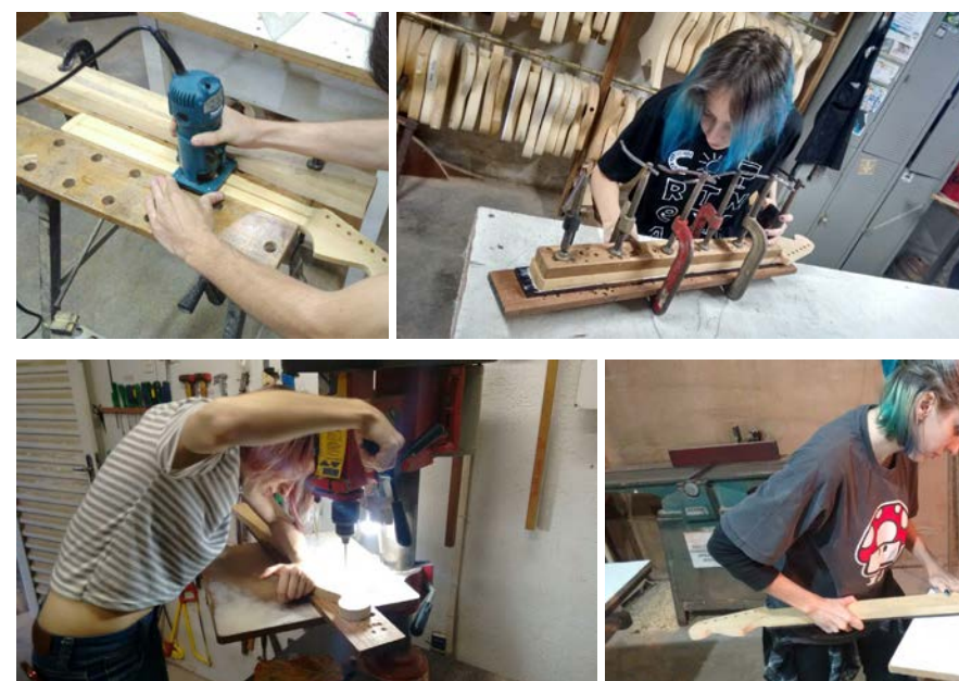
Figuras 155 e 156: abertura da cavidade do tensor e colagem da peça da escala no braço Figuras 157 e 158: furação de buraco para tarraxas e ajuste das laterais do braço
