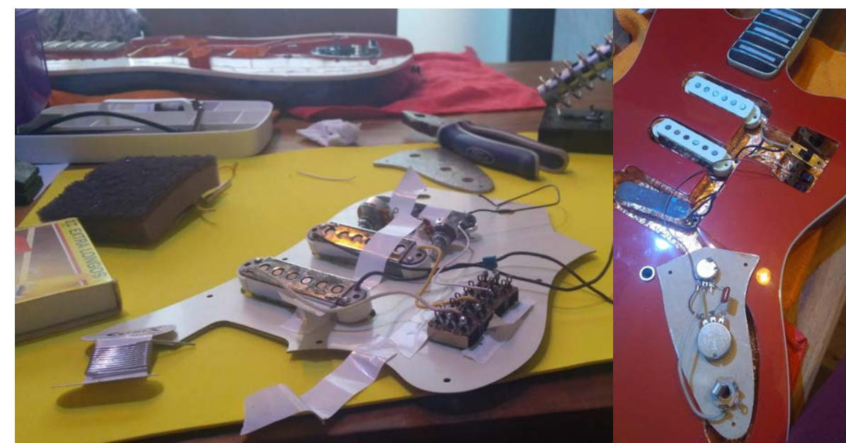
Figuras 178 e 179: Circuito em processo de soldagem.
