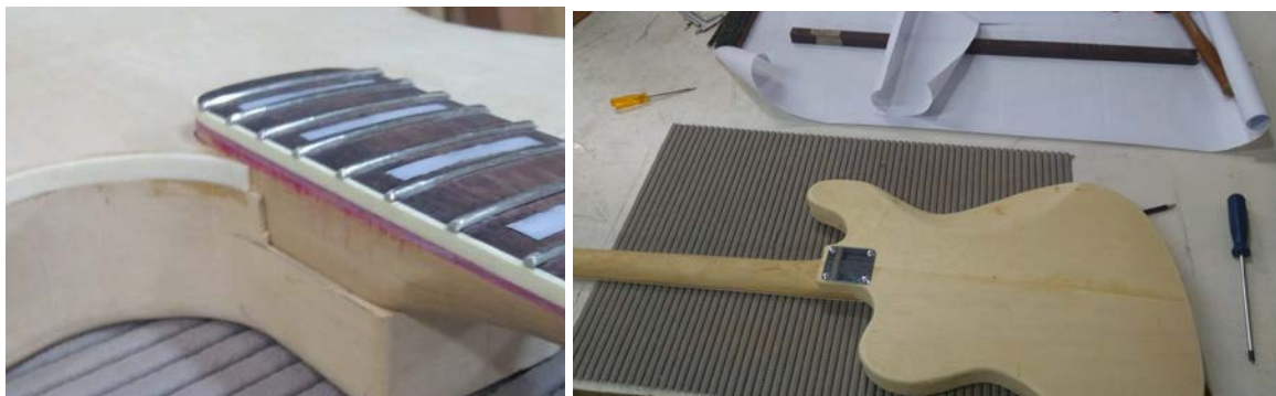
Figuras 164 e 165: encaixe das peças e furação dos parafusos de fixação
