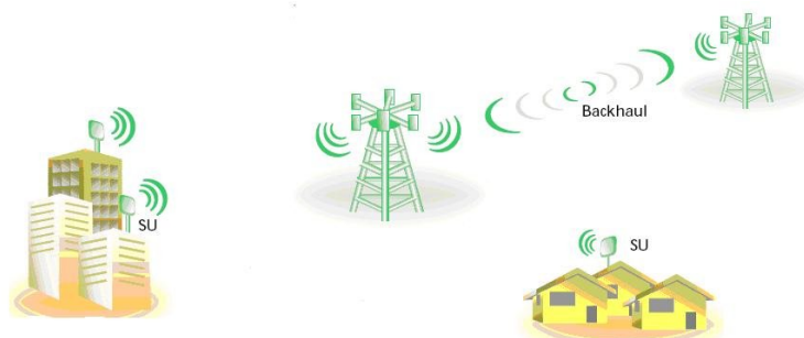
Figura A2.2 - Diagrama básico de interconexão de um enlace geral envolvendo uma conexão Backhaul* e uma conexão ponto-multiponto.
