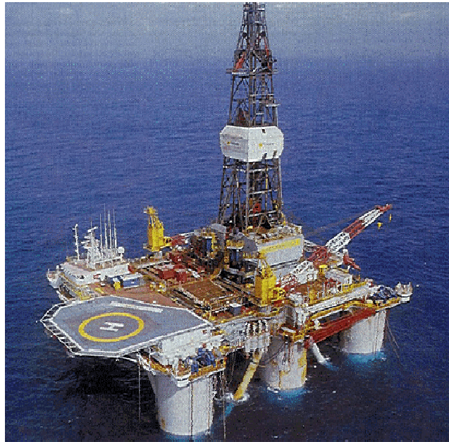
Figura 22- Plataforma flutuante semissubmersível Fonte: Acervo Pessoal.
