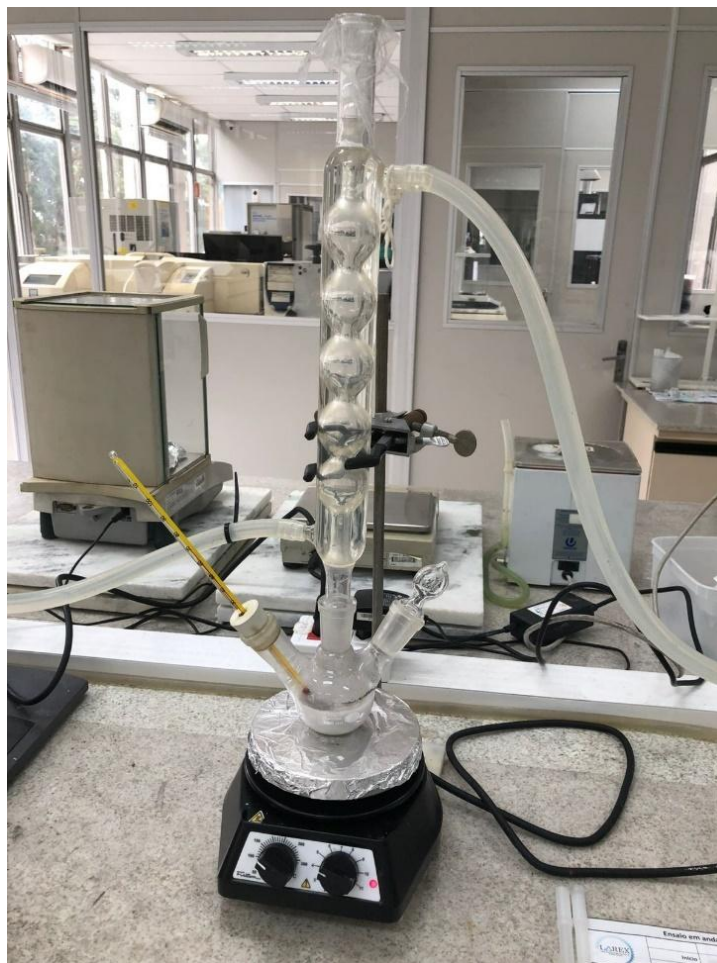
Figura 4 - Configuração dos ensaios de lixiviação
