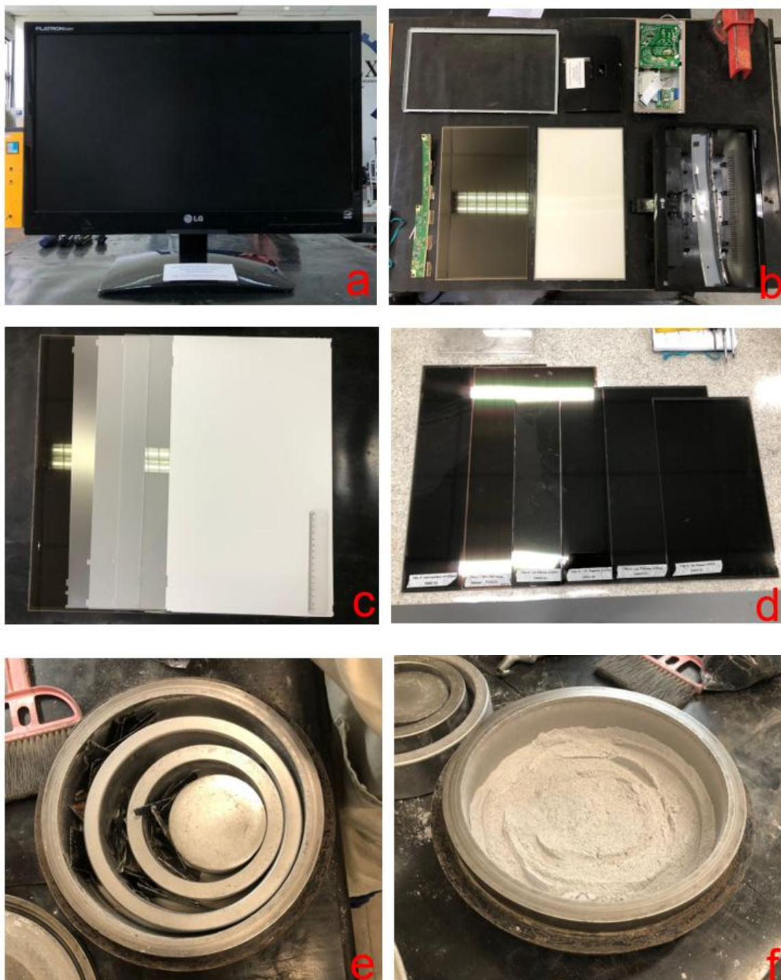
Figura 2 - Etapas de desmantelamento e cominuição das telas de LCD: (a) monitor completo; (b) monitor desmontado; (c) tela de LCD e folhas difusoras de luz; (d) telas dos seis monitores coletados; (e) panela de tungstênio do pulverizador; (f) tela cominuída
