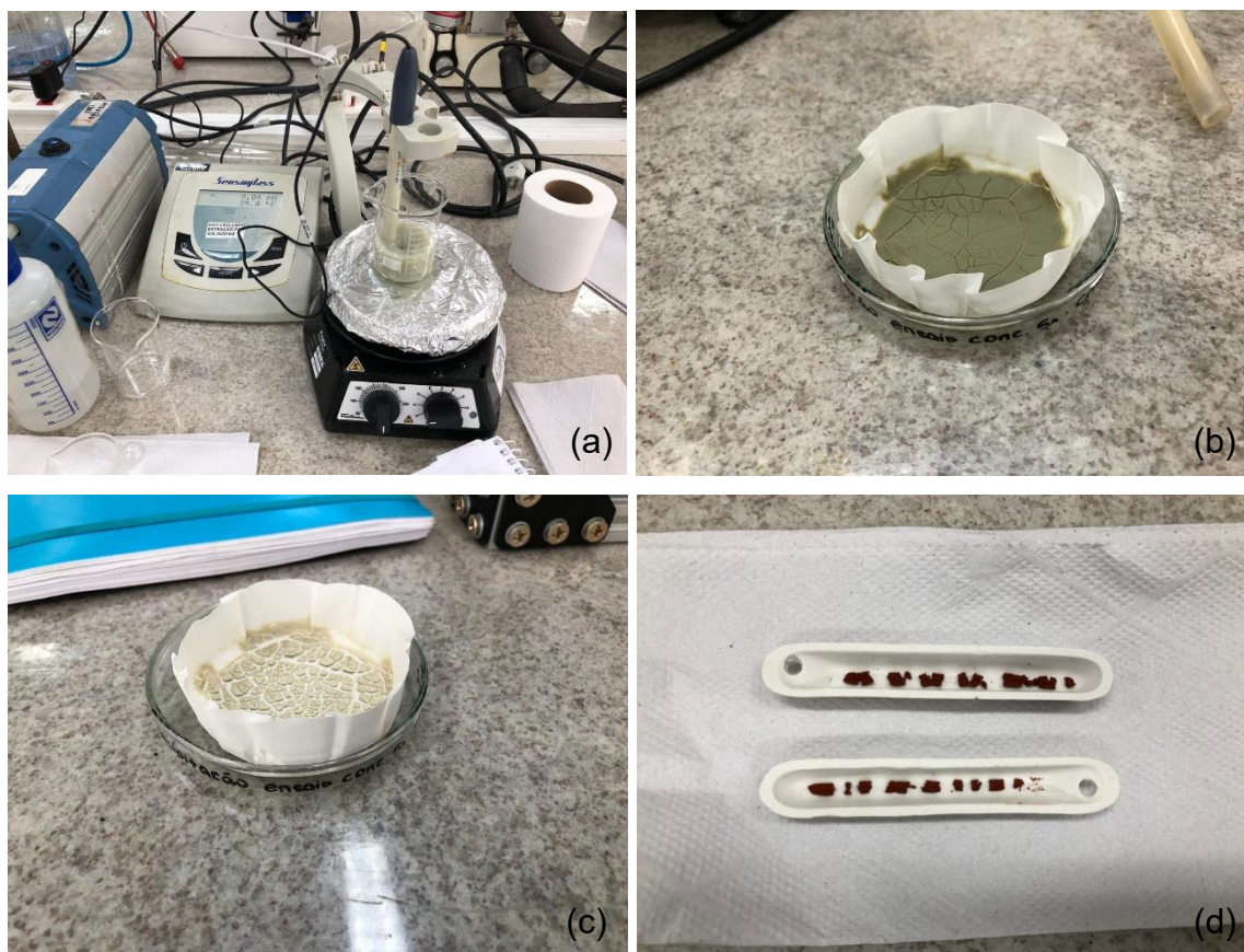
Figura 14 - (a) Ensaio preliminar de precipitação; (b) precipitado resultante após filtração à vácuo; (c) precipitado após secagem em condições ambientes; (d) precipitado após calcinação
