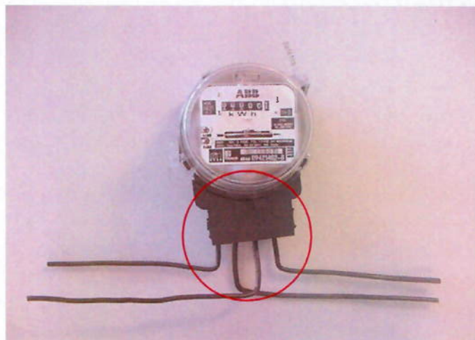
Figura 13 – Inversão da entrada e saída do medidor
