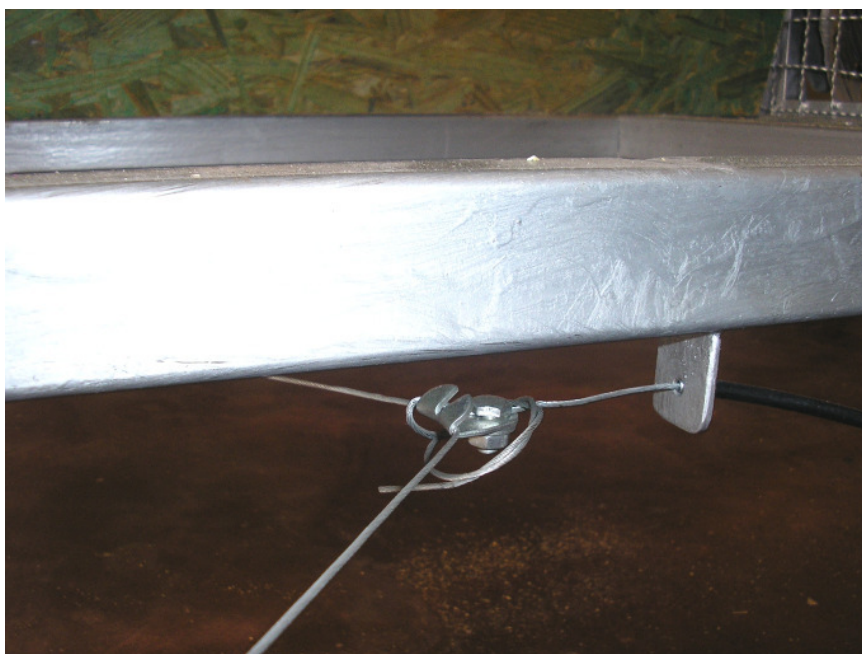
Figura 65: Detalhe do puxador do cabo de aço equalizador.
