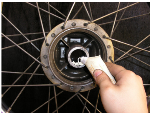
Figura 55: Aplicação da graxa no alojamento do rolamento.
