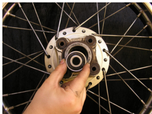
Figura 56: Colocação do rolamento 6302, que ficará no lado da roda voltado para a parte externa do veículo (ou o lado da relação da motocicleta).
