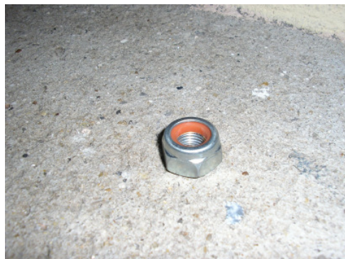
Figura 62: Detalhe da porca do eixo com o anel de segurança.
