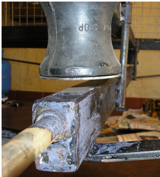
Figura 47: Detalhe da montagem do eixo (sem o fixador do espelho do freio) e sua relação com o coxim e com o chassi do veículo.
