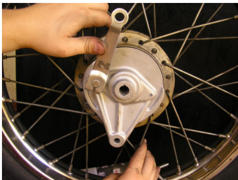
Figura 61: Vista do conjunto de freio montado, com o espelho e a alavanca de acionamento (excêntrico).
