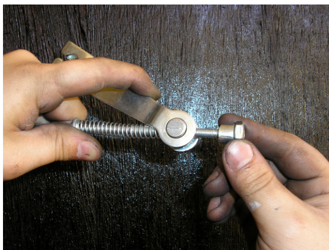
Figura 63: Conexão do excêntrico com a haste (vareta).
