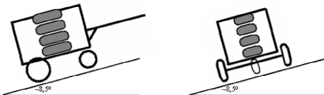
Figura 78: Teste de estabilidade. Situação de tombamento traseiro (esq.) e lateral (dir.).
