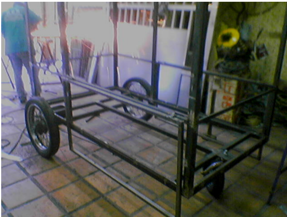
Figura 48: Vista do protótipo com a estrutura dos quadros definida e os quadros articulados já soldados.
