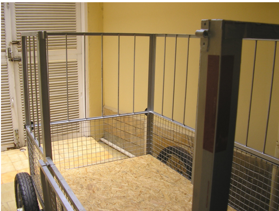
Figura 74: Detalhe do compartimento de carga com o quadro superior rebaixado.
