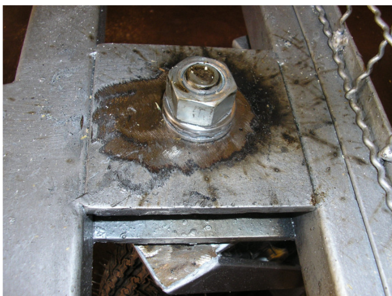
Figura 54: Vista superior do acoplamento do rodízio ao chassi (parte interna da carroceria).
