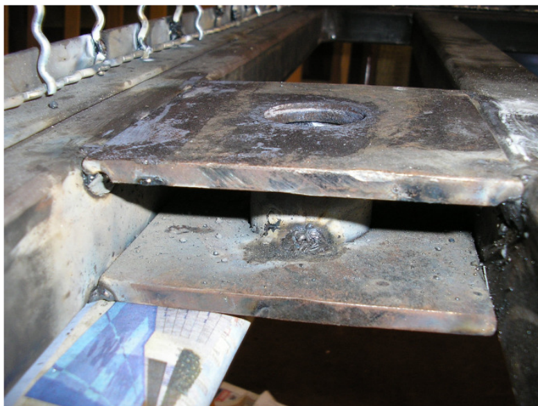
Figura 52: Detalhe do chassi onde seria instalado o rodízio.
