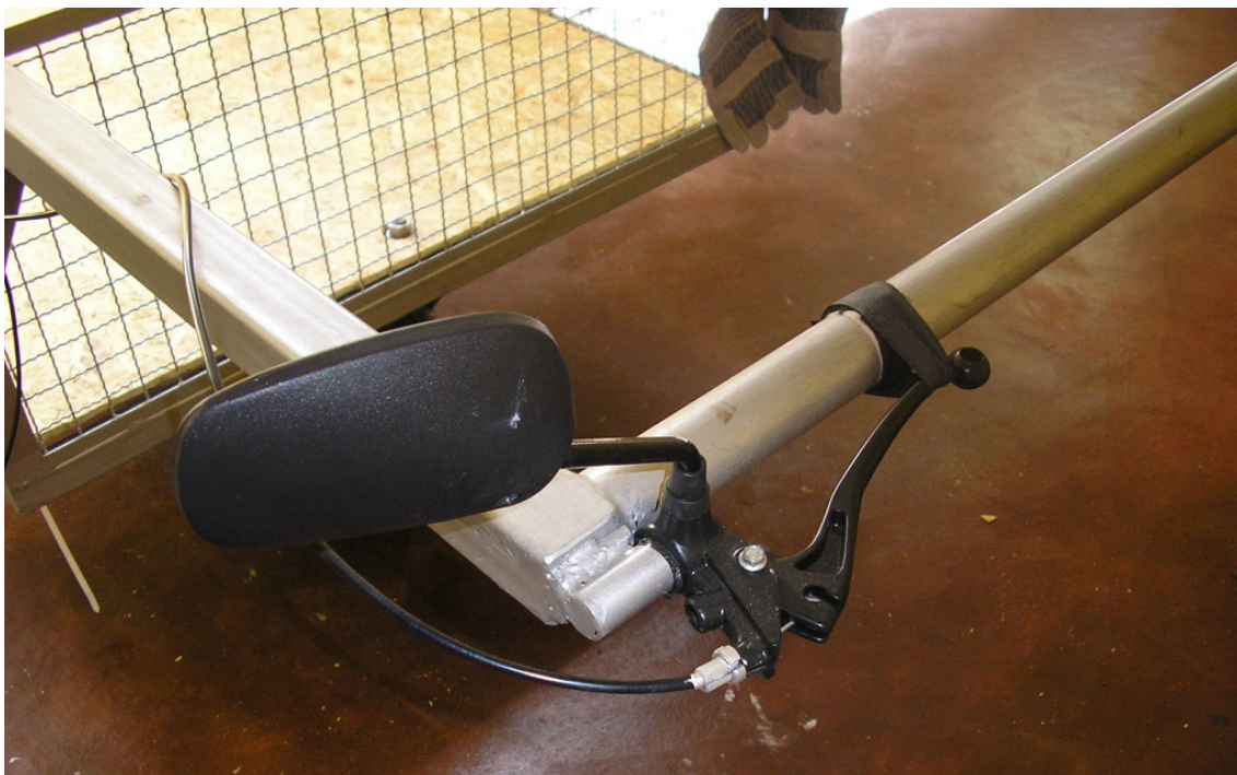
Figura 69: Vista do manete com a trava de velcro atuando.
