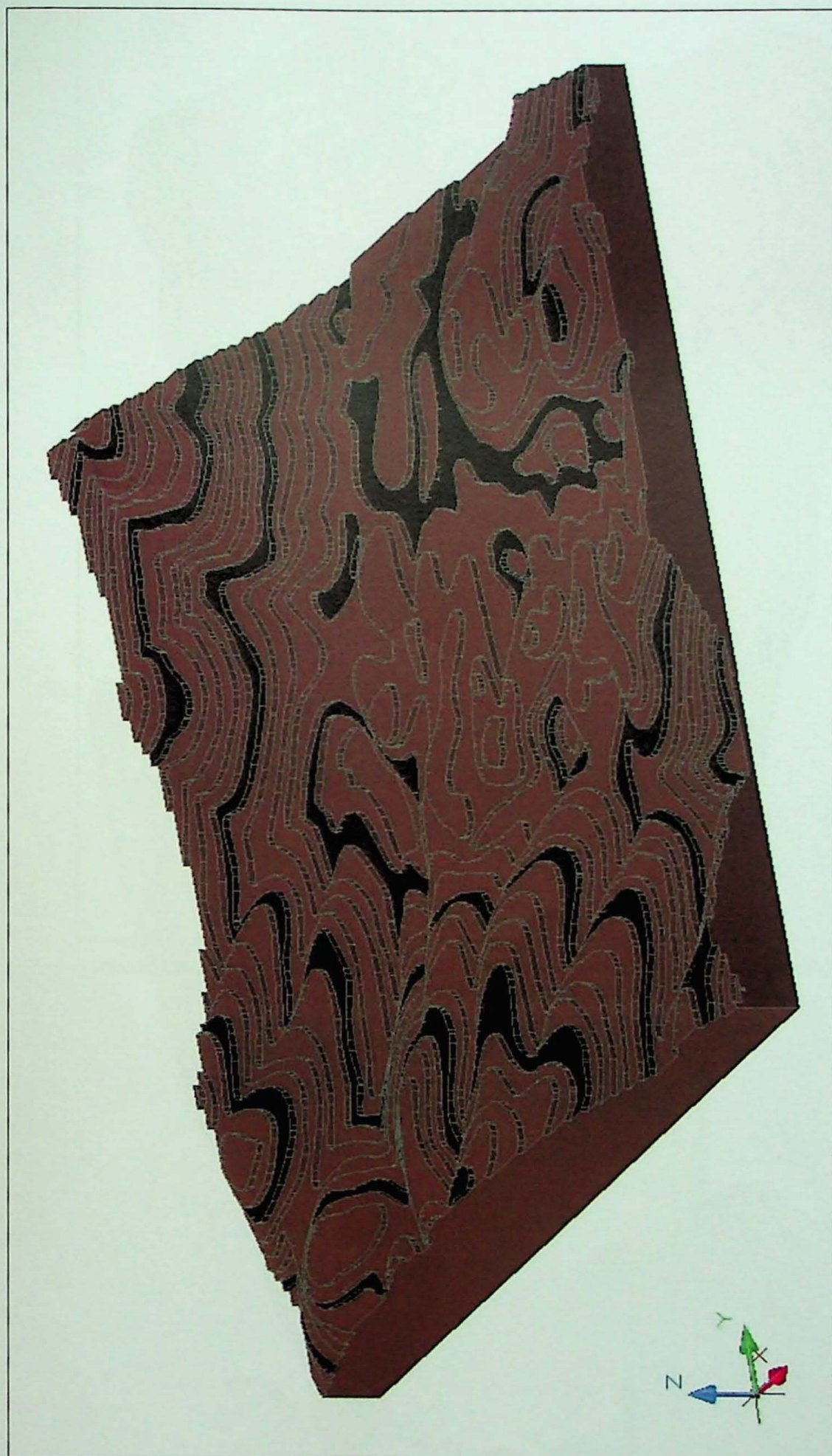
Figura 16 – Sólido de uma superfície topográfica construído com o comando thickness .
