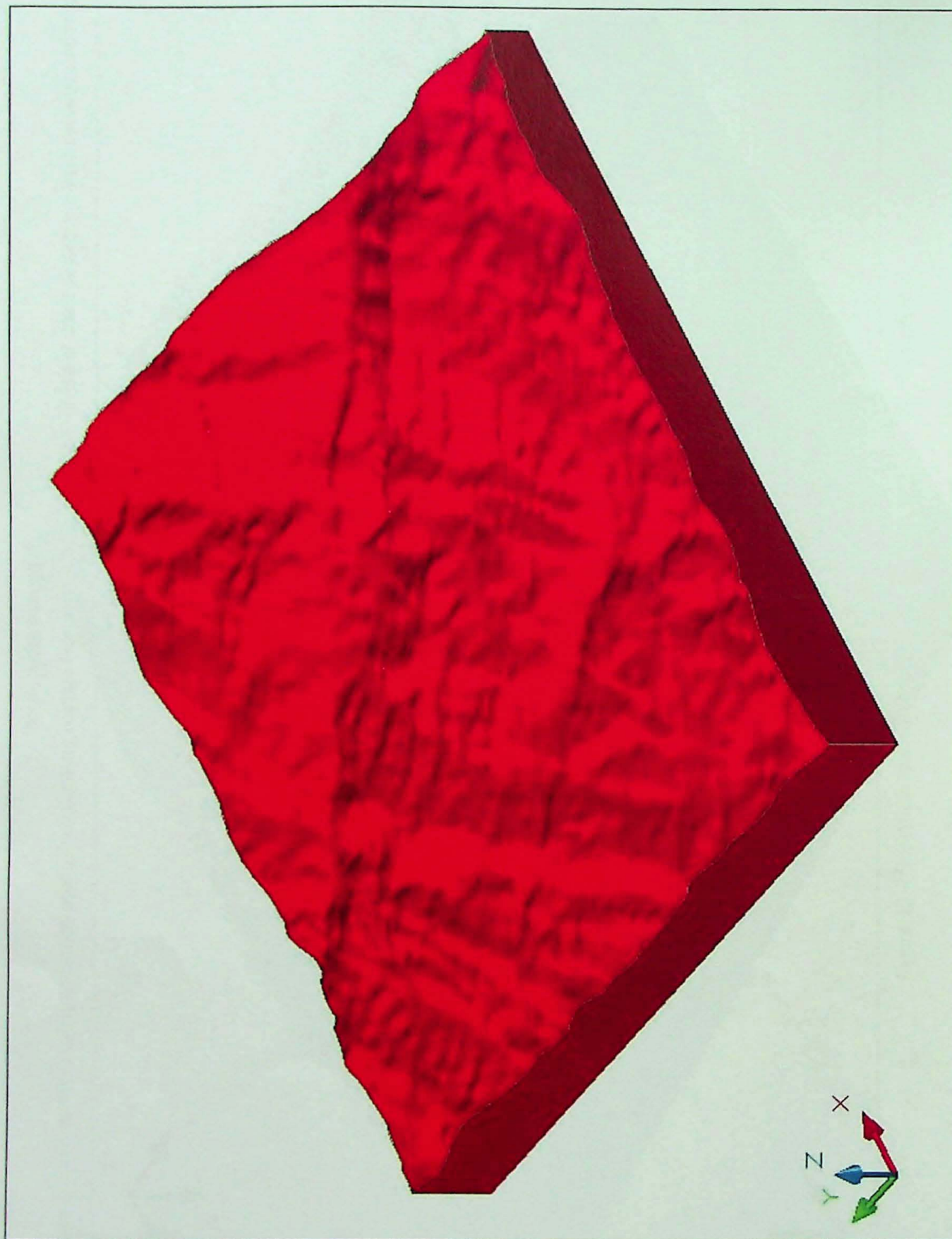
Figura 15 – Sólido da superfície topográfica construído com o comando slice . Vista isométrica.
