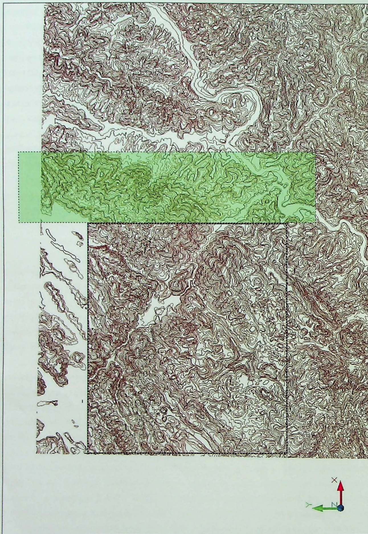
Figura 7 – Recorte da área de interesse retirada da Folha Iporanga (1:50.000, SG.22-X-B-V-2), usando o comando trim . Vista em planta, eixo Y = Norte, X = Leste, Z = vertical para cima.
