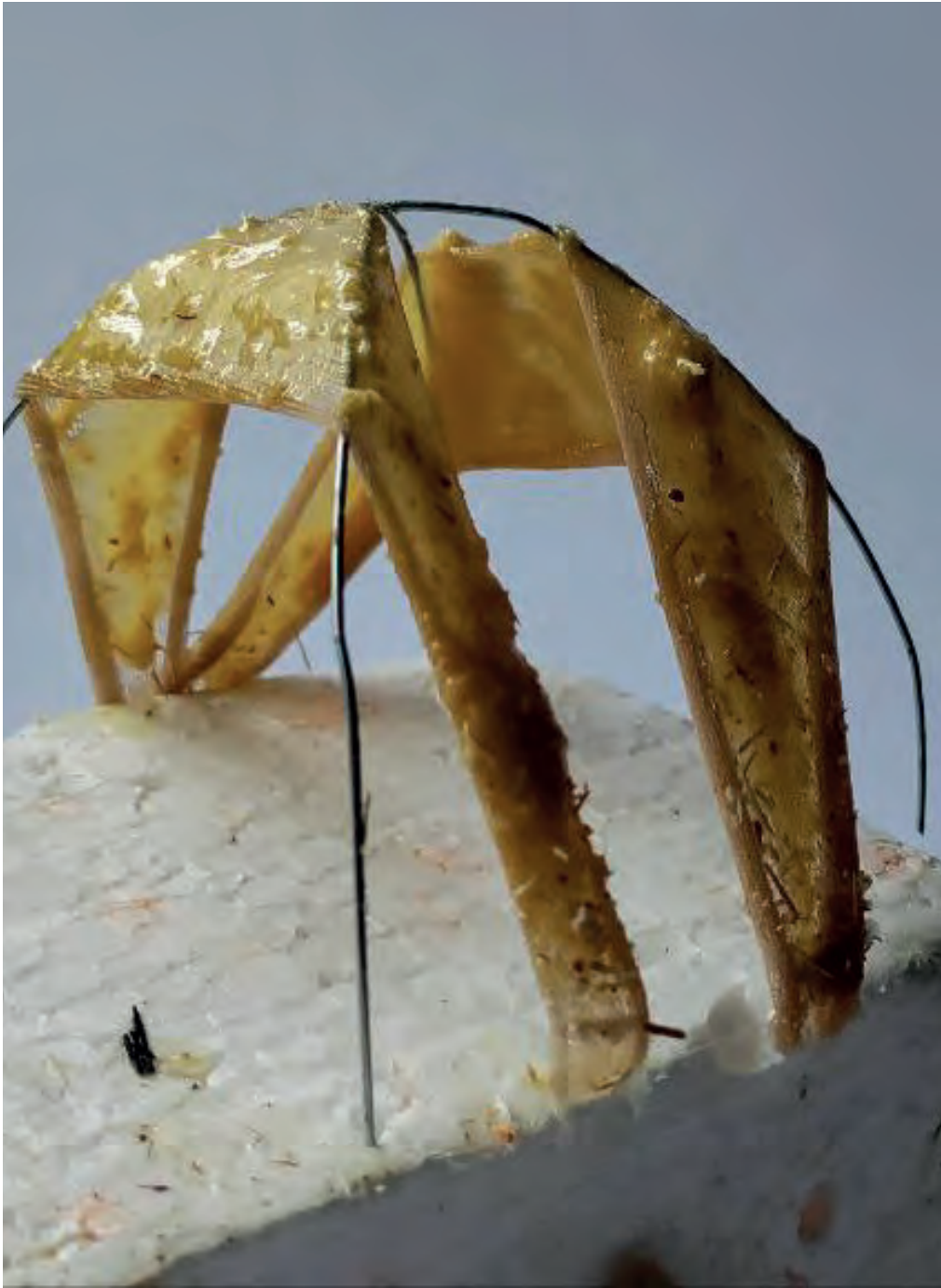
Estruturas pré-tensionadas, fixadas por resina + fibras: bagaço
