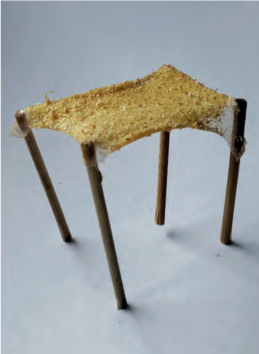
Estruturas pré-tensionadas, fixadas por resina + fibras: Apenas bagaço
