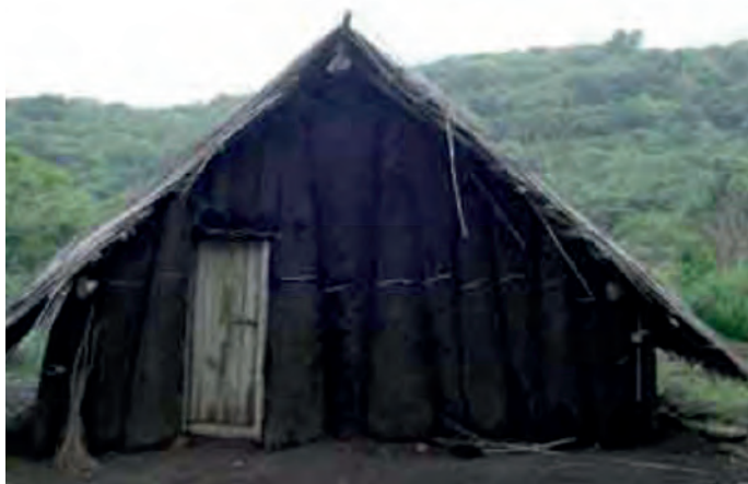
Figura 19 - Uso de xaxim e coco para paredes.
