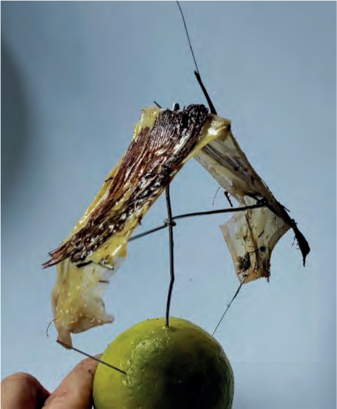
Estruturas pré-tensionadas, fixadas por resina + fibras: Apenas coco
