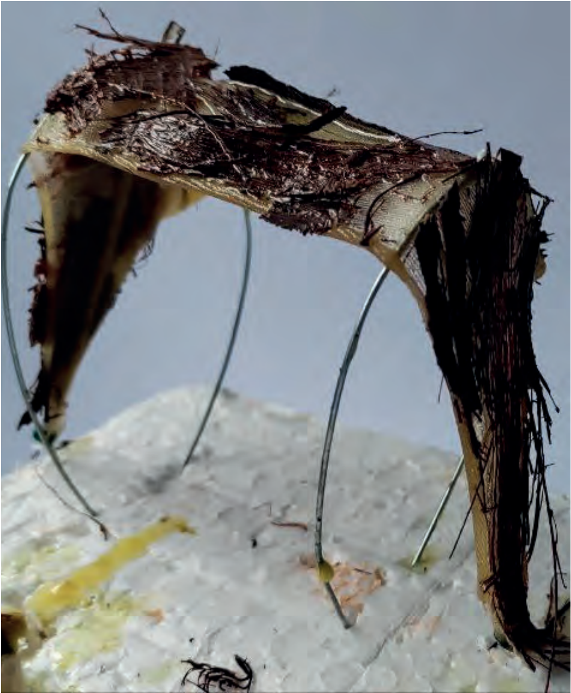
Estruturas pré-tensionadas, fixadas por resina + fibras: coco
