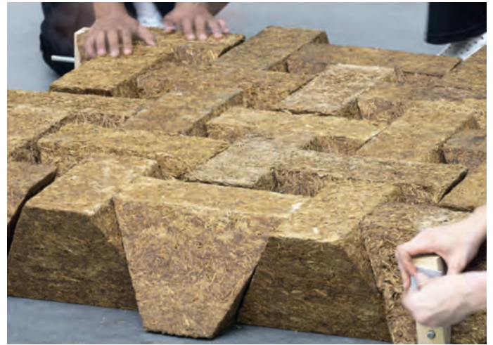
Figura 43 - Tijolos de cana-de-açúcar; um projeto estudantil que utiliza tijolos de cana-de-açúcar foi lançado como um método de construção alternativo.
