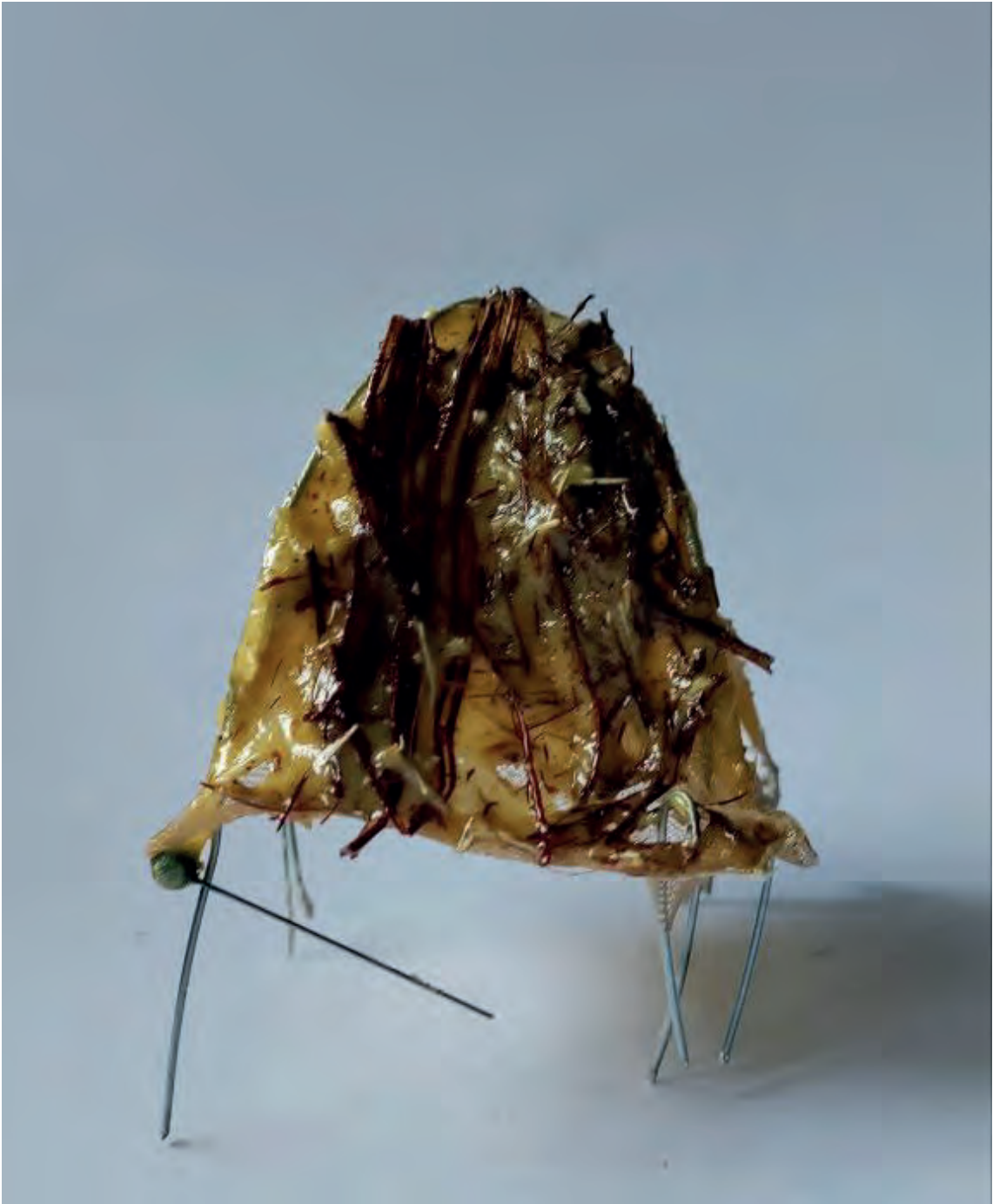
Estruturas pré-tensionadas, fixadas por resina + fibras: Coco + bagaço
