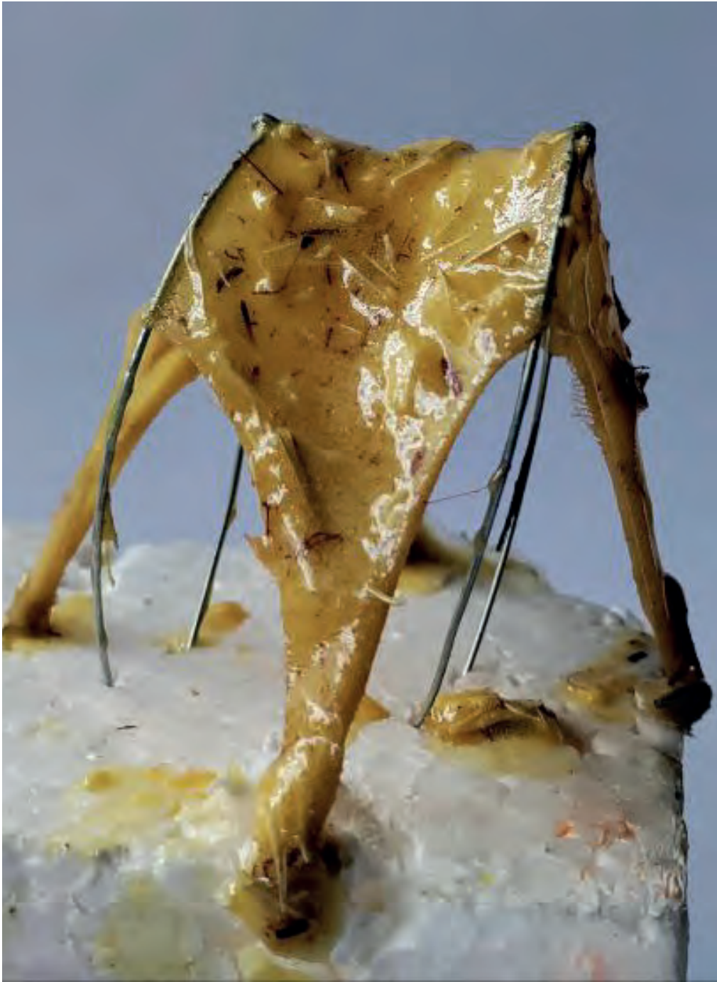
Estruturas pré-tensionadas, fixadas por resina + fibras: Bagaço + coco + serragem
