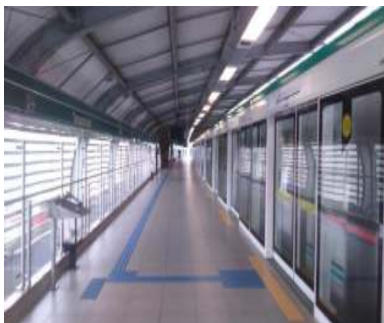
Foto 31 - Plataforma com portas-plataforma na estação Tamanduateí da Linha 2-Verde (metrô)
