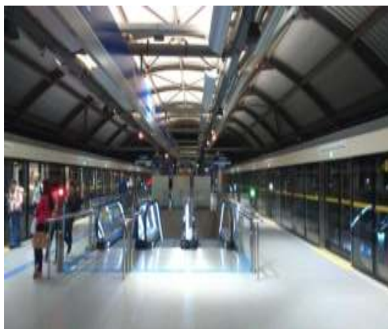
Foto 30 - Plataforma com portas-plataforma na estação Oratório da Linha 15-Prata (monotrilho).
