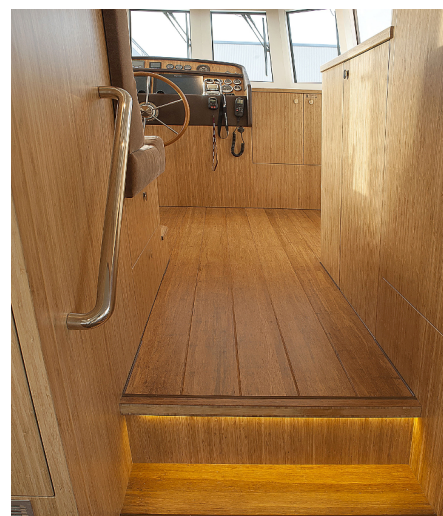
Esq.: Fig. 15 - Painéis de plyboo utilizados como revestimento e piso em embarcações (fonte: moso-bamboo.com). Dir.: Fig. 16 - manta de fibra de coco (fonte: archiexpo.com)
