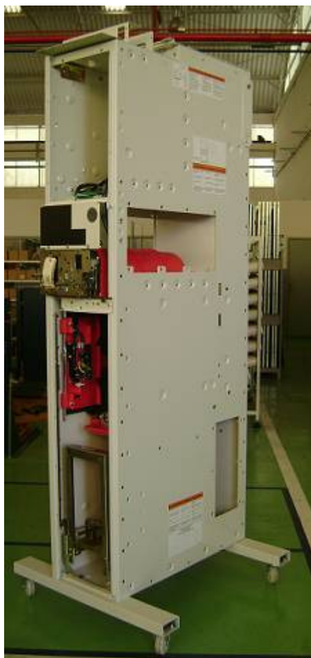
Figura 35. 1º Protótipo Nacional – Motorpact .
