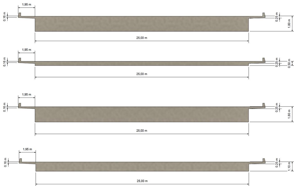
Figura 35 - Vigas transversinas e suas dimensões.
