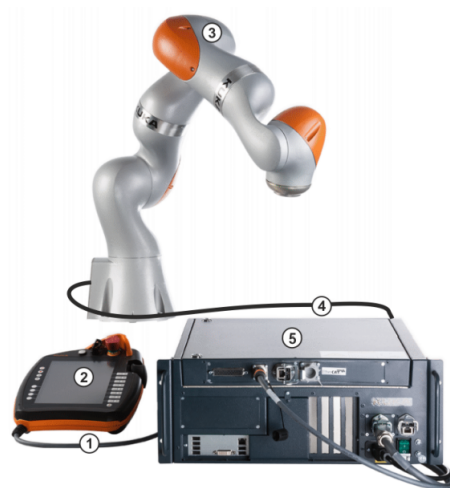
Figura 3.2: Sistemas do LBR iiwa: (1) Cabo de conexão com SmartPad ; (2) Painel de controle do SmartPad ; (3) LBR iiwa; (4) Cabo de conexão com KUKA Sunrise; e (5) Controlador do KUKA Sunrise (KUKA Robotics, 2023a).
