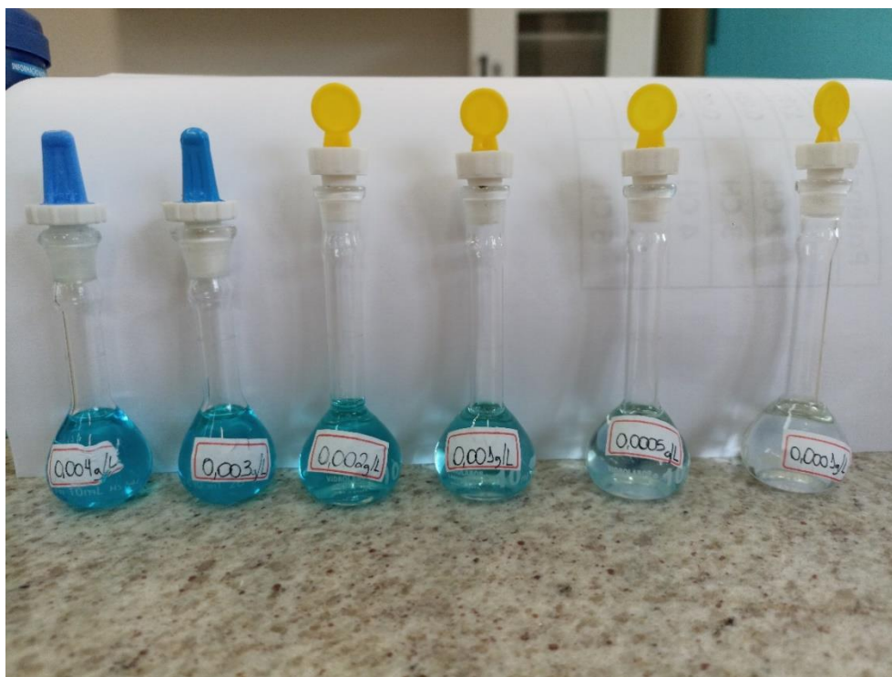
Figura 8 – Balões volumétricos com várias concentrações de azul de metileno em g/L, da maior concentração na esquerda para menor concentração na direita.
