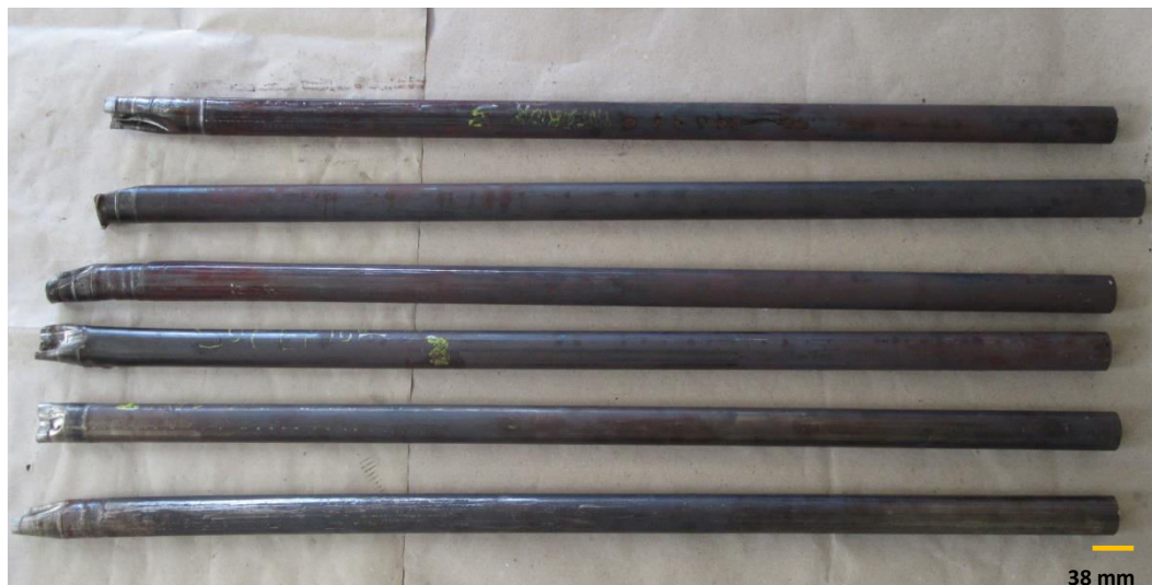
Figura 6 – Tubos tais como recebidos para análise laboratorial.
