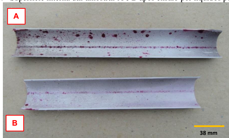
Figura 14– Superfície interna das amostras A e B após ensaio por líquidos penetrantes.
