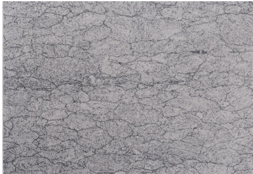
Figura 3 – Imagem representativa mostrando contornos de grãos austeníticos pré-existente e a matriz martensítica com aumento de 1000X. Ataque: Vilella.
