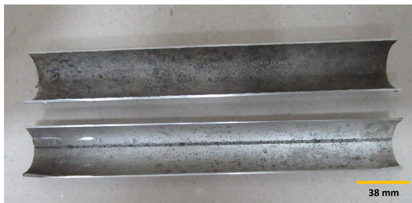
Figura 8 – Imagem representativa mostrando como foram efetivados os cortes.
