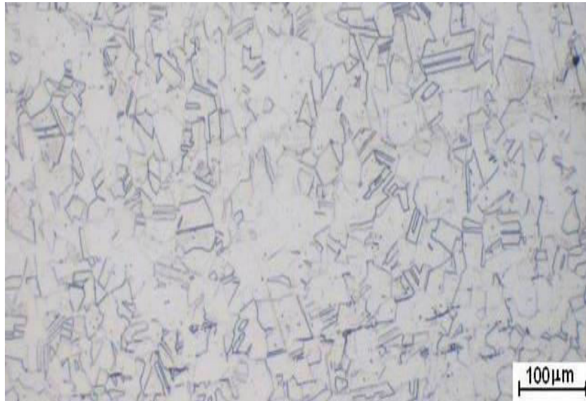
Figura 1 - Imagem representativa da microestrutura de aços inoxidáveis austeníticos com a presença de maclas de recozimento. Ataque: Água régia.
