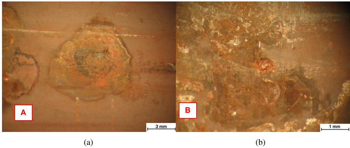
Figura 16 a) e b) – Imagem dos pites vistos pela superfície externa anteriormente à limpeza.
