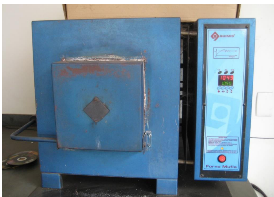
Figura 9 – Forno utilizado para o tratamento térmico de solubilização.
