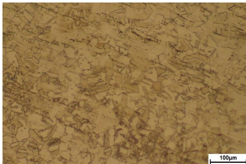
Figura 19 – Imagem representativa da microestrutura encontrada no material-base das amostras A e B. Ataque: água régia.
