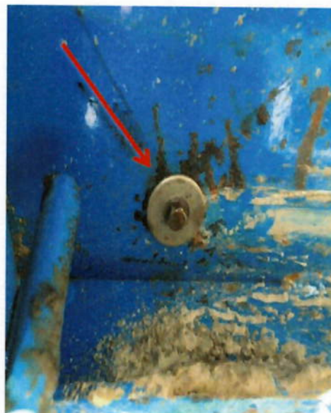
Foto 6.12: Inserto para içamento posicionado na forma (lado externo) - (Fonte: Autora)
