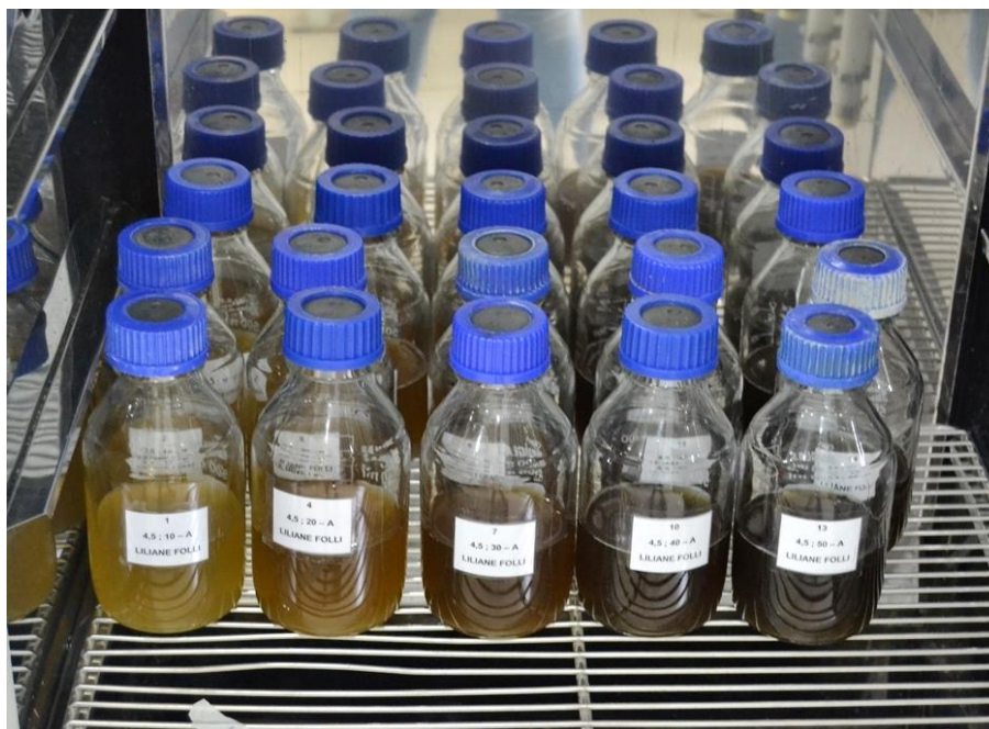
Figura 10 – Sistema em batelada disposto em câmara aquecida para armazenamento
