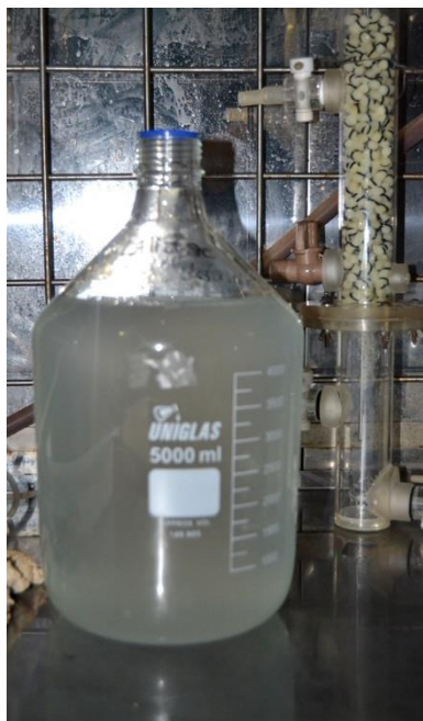
Figura 7 – Meio de alimentação sendo inoculado por meio do processo de fermentação natural dentro da câmara de reatores.
