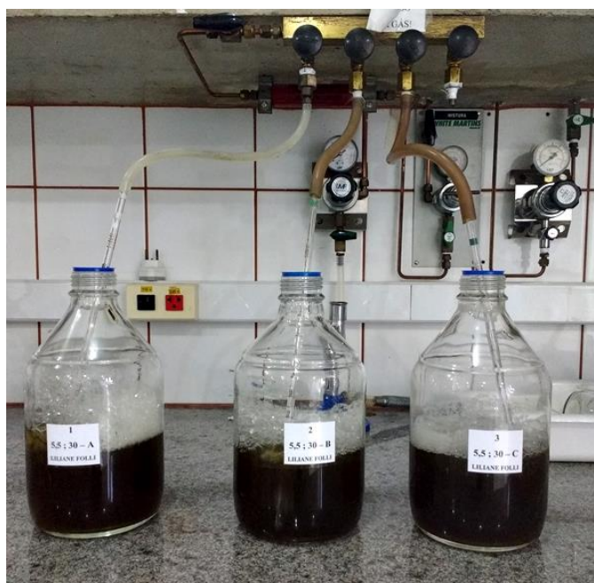
Figura 11 – Reatores em batelada recebendo gás nitrogênio (N 2 )
