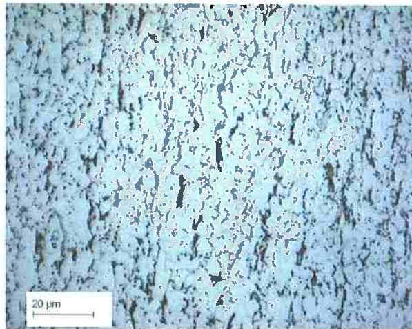
Figura 64: A563. Le Pera; Ciclo 4, 70% def. ( 1.00s^{-1} ); 10^{\circ}C/s a 550^{\circ}C seguido de resfriamiento lento ( 200^{\circ}C ).
