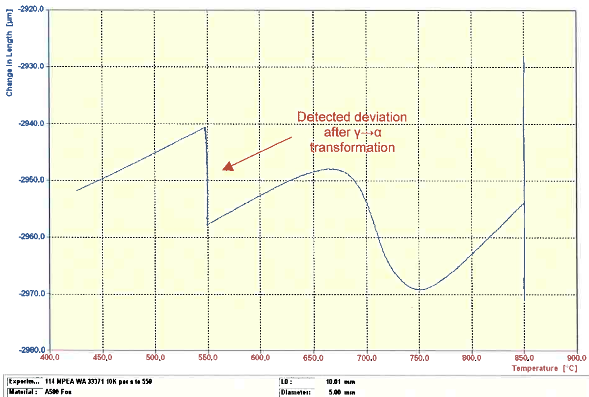
Figura 26: A580. Curva da mudança de comprimento versus temperatura durante o resfriamento rápido. Ciclo1; 30% de deformação ( 0.01 \text{ s}^{-1} ; 10^\circ\text{C/s} a 550^\circ\text{C} e resfriamento lento a 200^\circ\text{C} ). Software do dilatômetro Bähr (DIL805 WinTA9.0).
