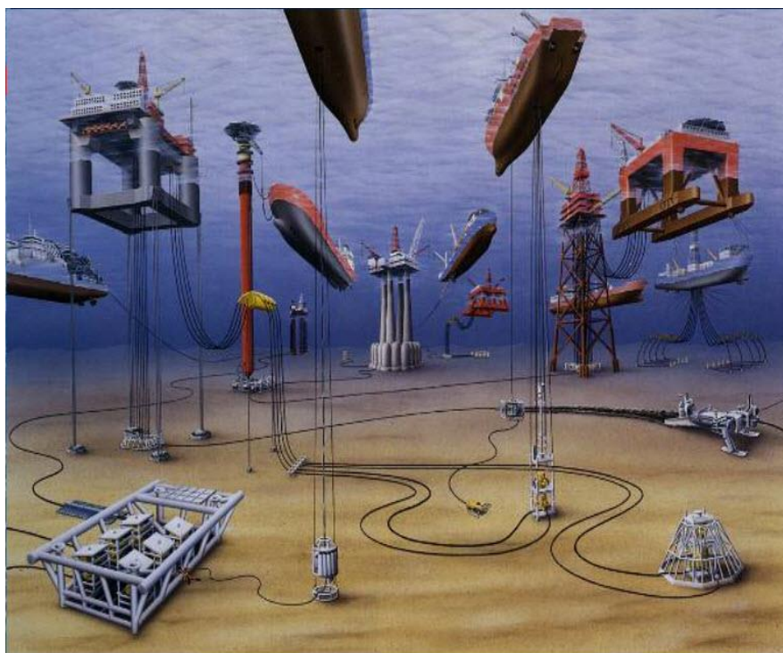
Figura 2 - Elementos de ligação são responsáveis por interligar as plataformas às unidades de extração presentes no leito do oceano. Fonte: (2B1st Consulting, 2014).
