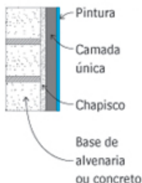
Figura 5 - Ilustração das principais camadas do revestimento.
