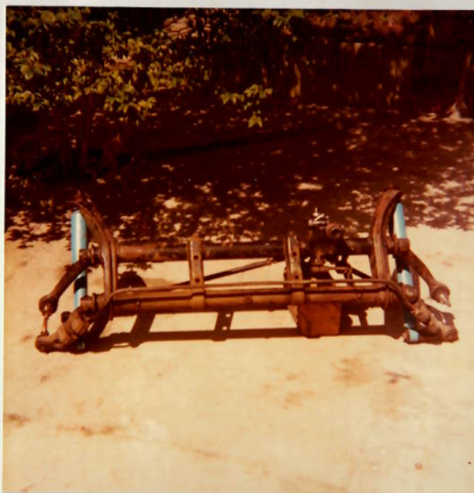
Foto 25 : Vista frontal da suspensão dianteira ( VW Sedan 1300 ).
