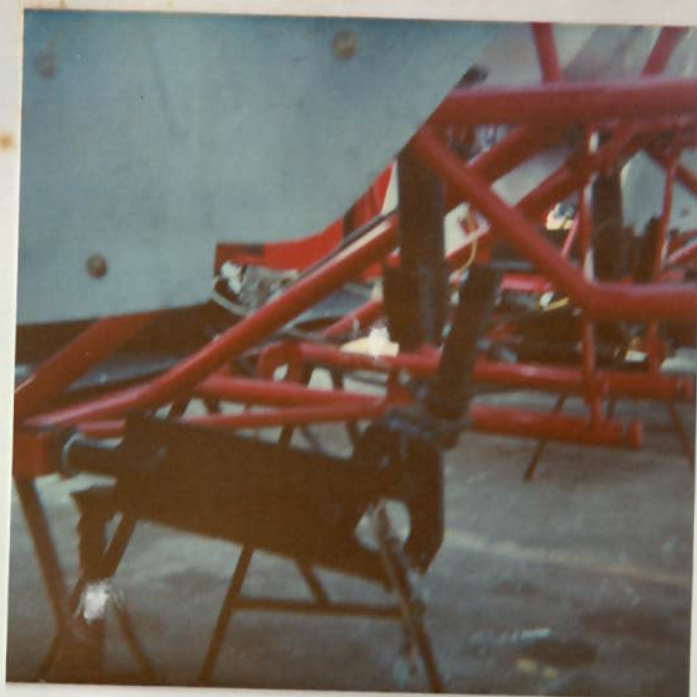
Foto 13 : Visita à fábrica de veículos de estrutura tubular Cronos. Detalhe da suspensão traseira e fixação da caixa de câmbio do veículo Crotalus.
