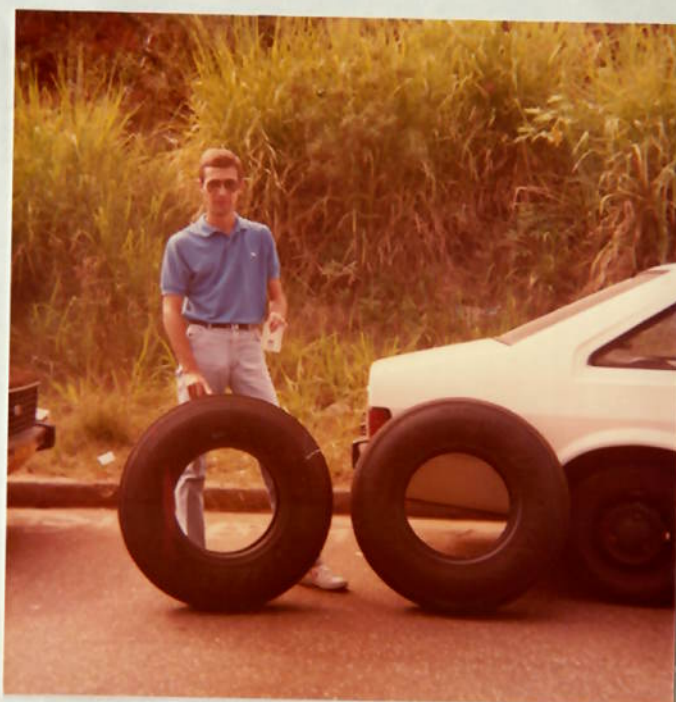
Foto 30 : Pneus do trem de pouso principal do avião Fokker cedidos pela TAM - Taxi aéreo Marília. Posteriormente foi abandonado o projeto de utilização destes pneus no veículo devido a problemas com o licenciamento deste e necessidade de fabricação de aros especiais. Na foto Francisco Claudio Abreu Santos.
