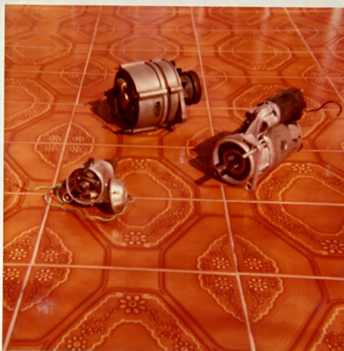
Foto 32 : Da esquerda para a direita : distribuidor, alternador e motor de arranque; todos de Passat.
