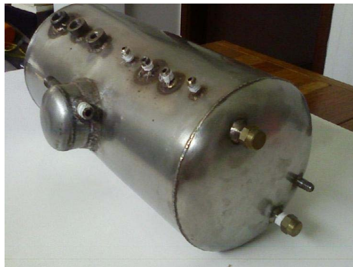
Figura 9: Caldeira sem equipamentos acoplados.
