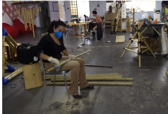
◀ Figura 51. Corte das varas de bambu. Foto da autora.
