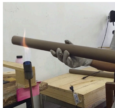
◀ Figura 55. Confecção do gabarito para compor a prensa. Foto da autora.
