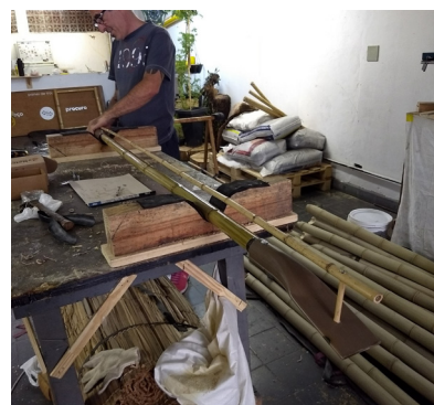
◀ Figura 59. Secagem das barras compostas pelas varas de bambu e conectores de cano PVC. Foto da autora.
