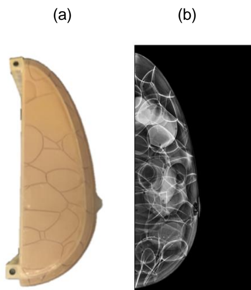
Figura 10:(a) “Phantom” antropomórfico; (b) exemplo de uma projeção DBT do “phantom” (a).
