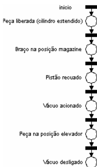
Figura 21 – Modelagem do funcionamento da estação de distribuição em rede de Petri
