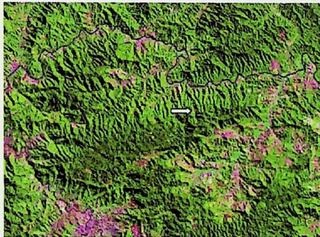
Imagem de satélite em composição colorida, TM 3(B) TM 4(G) e TM 5(R). A vegetação densa tem cor verde, as áreas desmatadas ou com vegetação baixa cor rosa e o rio Ribeira de Iguape cor azul, na parte de cima da imagem. A seta indica a localização da Caverna do Diabo.
