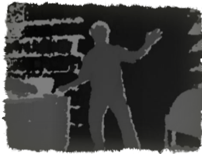
Figura 2.11: Imagem monocromática produzida pela câmera de profundidade [13].
