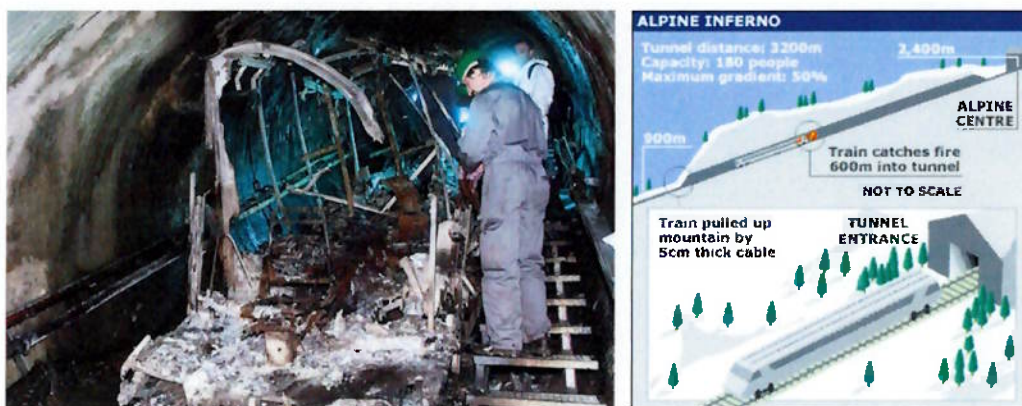
Figura 3 – Túnel do funicular de Kaprun após o acidente de novembro de 2000 e esquema indicando o perfil do túnel (GUARDIAN, 2004; BBC NEWS, 2001)
