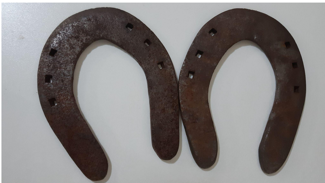
Figura 62. Par de ferraduras de esbarro utilizadas pelo Amarillo Del Rancho em 2017 e analisadas neste trabalho
