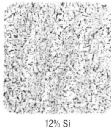
Figura 75 - Microestrutura do sistema Al-Si com 12% de Si (Moreira, 2020)
