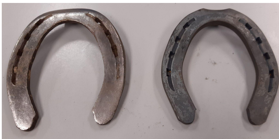
Figura 86 - Ferraduras de aço (pesadas) do Regimento, sendo a nova do lado direito e a usada do lado esquerdo
