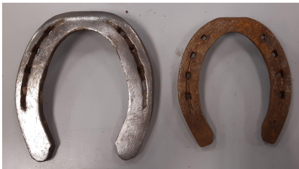
Figura 93 - Comparação do lado em contato com o solo da ferradura usada pelo Regimento (à esquerda) com a ferradura usada pelo Amarillo Del Rancho (à direita)
