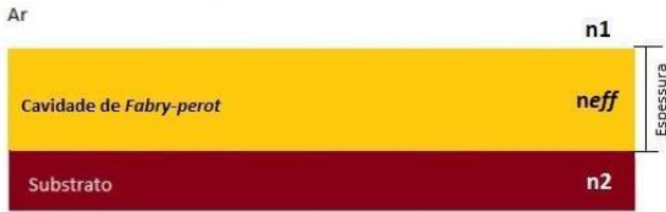
Figura 10 – Forma efetiva que a rede Subwavelength é enxergada pela onda incidente.
