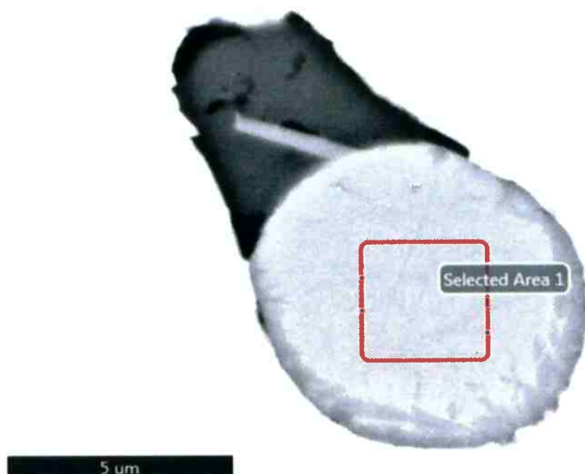
Figura 28 – Microestrutura de inclusão não-metálicas de Ipanema (amostra 134). Área avaliada no ensaio de EDS em destaque. Microscopia eletrônica de varredura, imagem por elétrons retroespalhados
