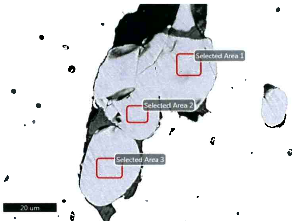
Figura 3 - Microestrutura de inclusões não-metálicas de Ipanema (amostra 132). Inclusão isolada, ligeiramente menor do que a média. Área avaliada ( A_4 ) no ensaio de EDS em destaque. Microscopia eletrônica de varredura, imagem por elétrons retroespalhados.
