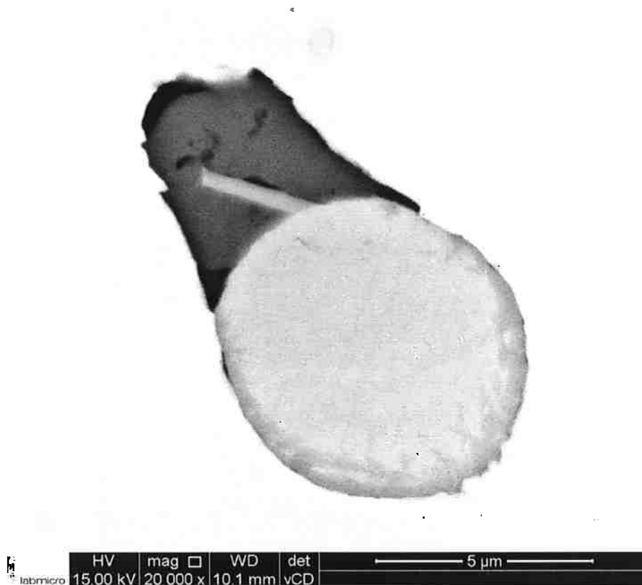
Figura 17 – Microestrutura de inclusão não-metálica de Ipanema (amostra 134). Wustita quase esférica com granulometria de aproximadamente 7 \mu m. Inclusão isolada. Microscopia eletrônica de varredura, imagem por elétrons retroespalhados.
