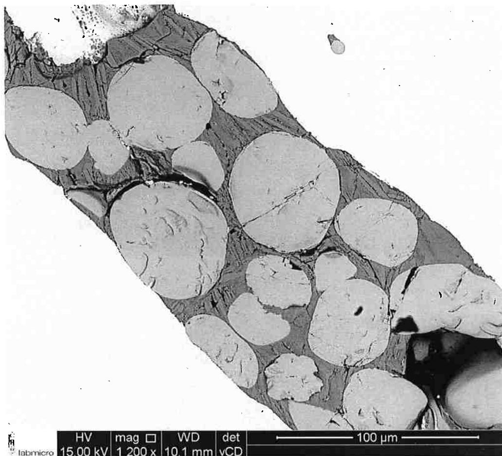
Figura 13 - Microestrutura de inclusões não-metálicas de Ipanema (amostra 134). Inclusão com regiões claras de geometria arredondada (wustitas) envolvidas por área escura. Microscopia eletrônica de varredura, imagem por elétrons retroespalhados.
