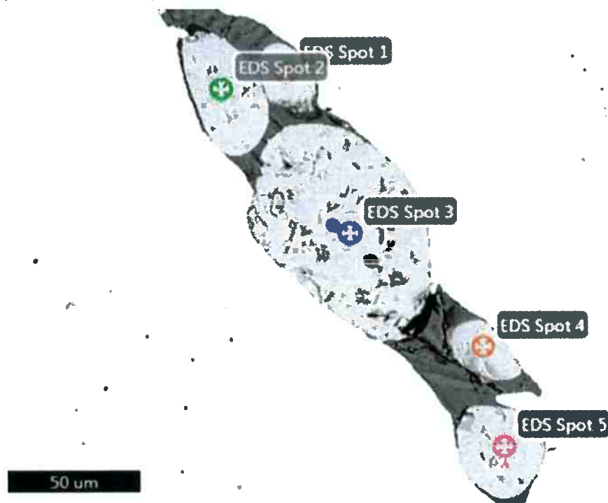
Figura 5 – Microestrutura de inclusões não-metálicas de Ipanema (amostra 134). Tamanho e formato próprios das inclusões aglomeradas da amostra, embora tenha composição semelhante às isoladas. Pontos avaliados (P 5 - P 10 ) no ensaio de EDS em destaque. Microscopia eletrônica de varredura, imagem por elétrons retroespalhados.
