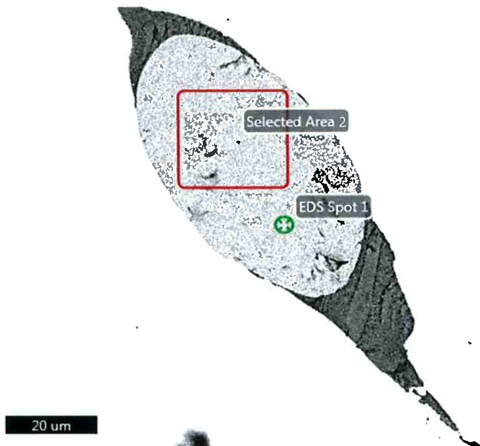
Figura 30 – Microestrutura de inclusão não-metálicas de Ipanema (amostra 134). Área e ponto avaliados no ensaio de EDS em destaque. Microscopia eletrônica de varredura, imagem por elétrons retroespalhados
