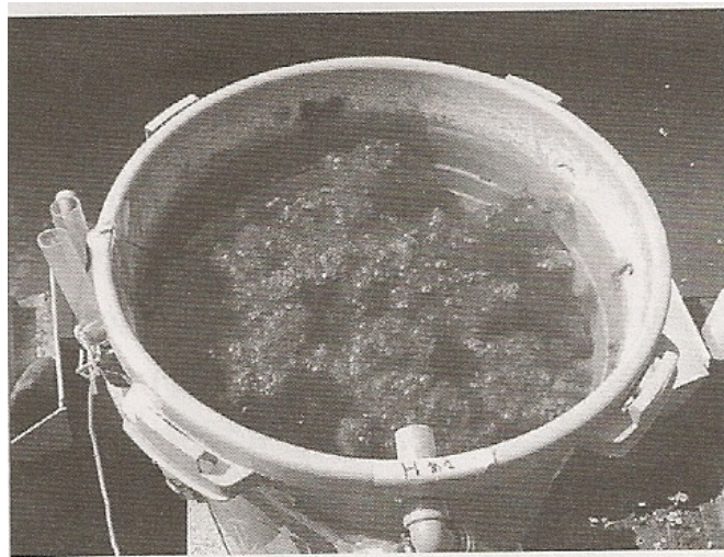
Figura 18. Destaque para o balde onde se processa filtração lenta, com acúmulo de algas na superfície. Entrada de água na parte superior e saída por mangueiras laterais. FONTE: Nakamoto (2009).
