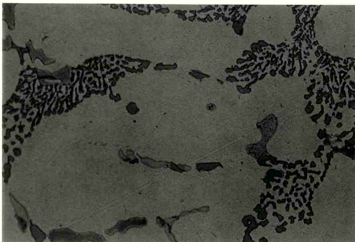
Figura 16: Microestrutura da liga A-319 modificada com a mistura (Sódio + Estrôncio) II (800x)
