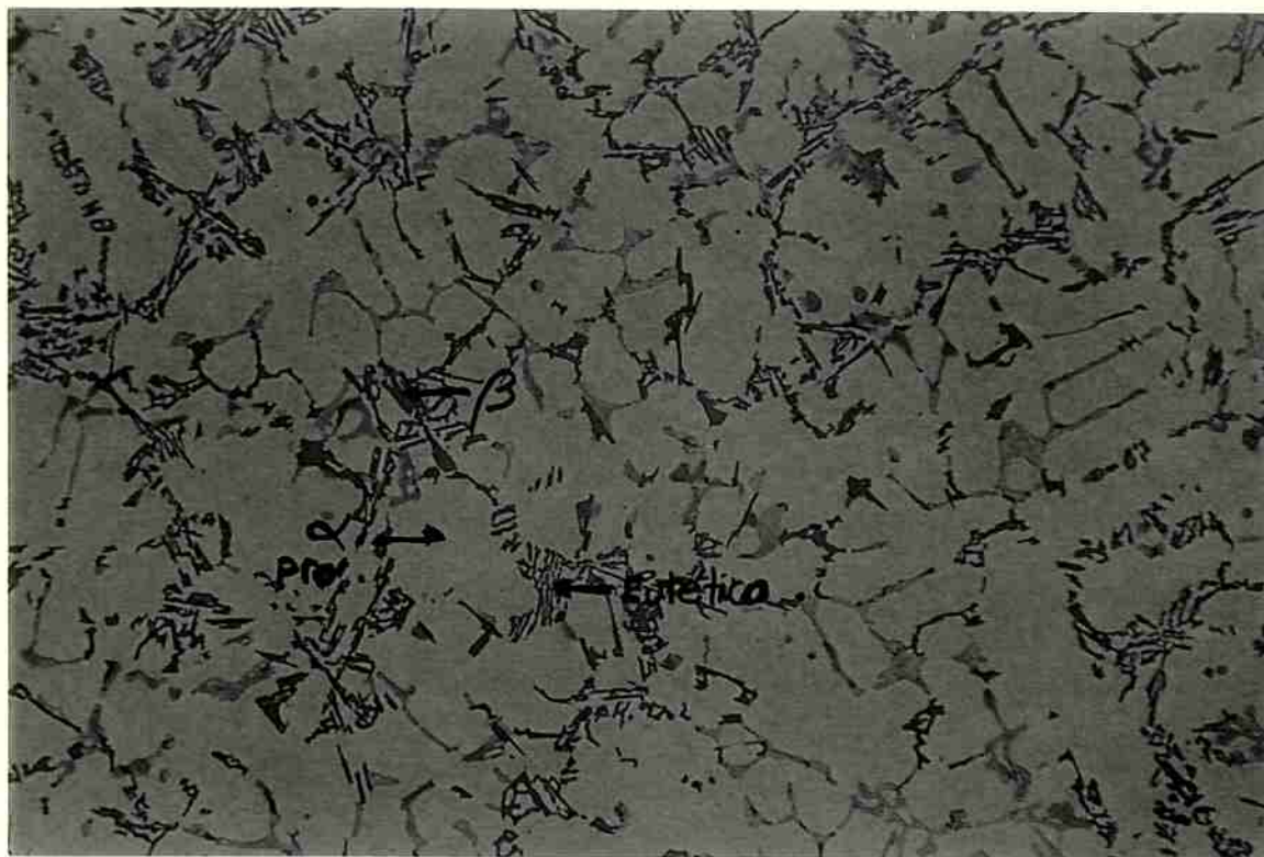
Figura 7: microestrutura da liga A-319 não-modificada indicando as fases presentes (200x)
