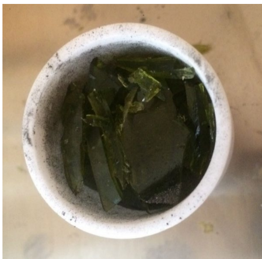
Figura 17: Preparação experimento 2 wootz.
