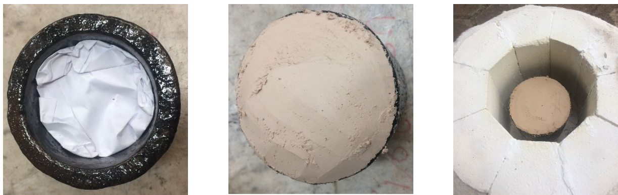
Figura 32: Passos de carregamento do cadinho no experimento 6.
