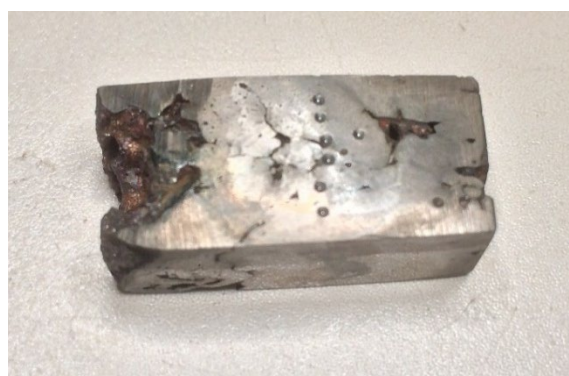
Figura 23: Wootz experimento 2, após forjamento.
