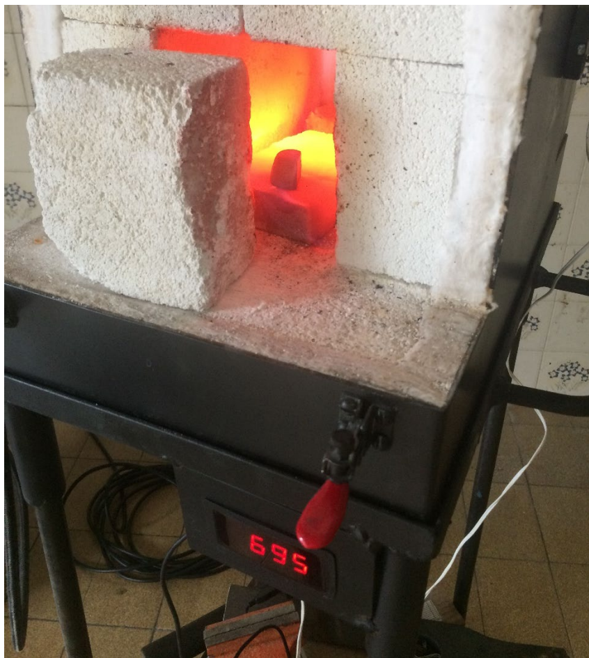
Figura 30: Temperatura de forjamento da amostra 5.
