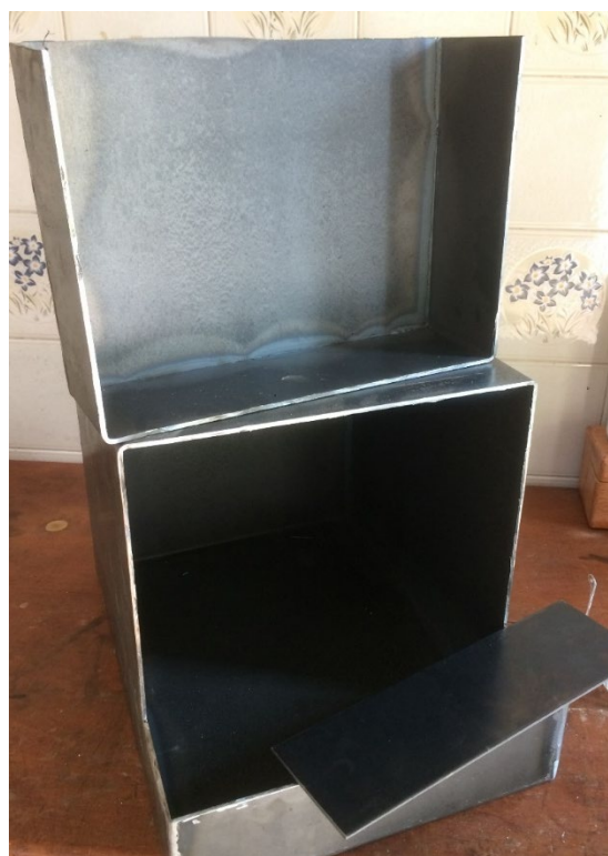
Figura 77: Porta cortada e a peça para soldar na parte inferior da porta.
