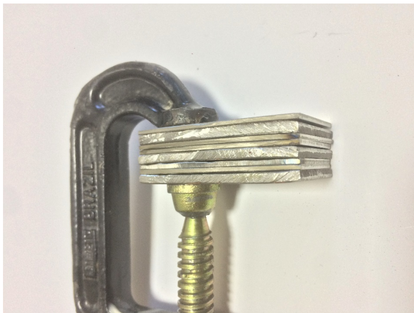
Figura 35: Componentes prontos para serem soldados com eletrodo revestido.
