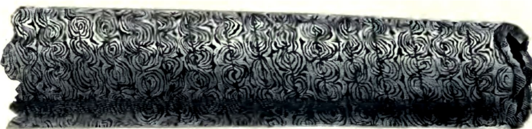
Figura 9: Cano de arma de Damasco de três barras(GREENER, 1910).
