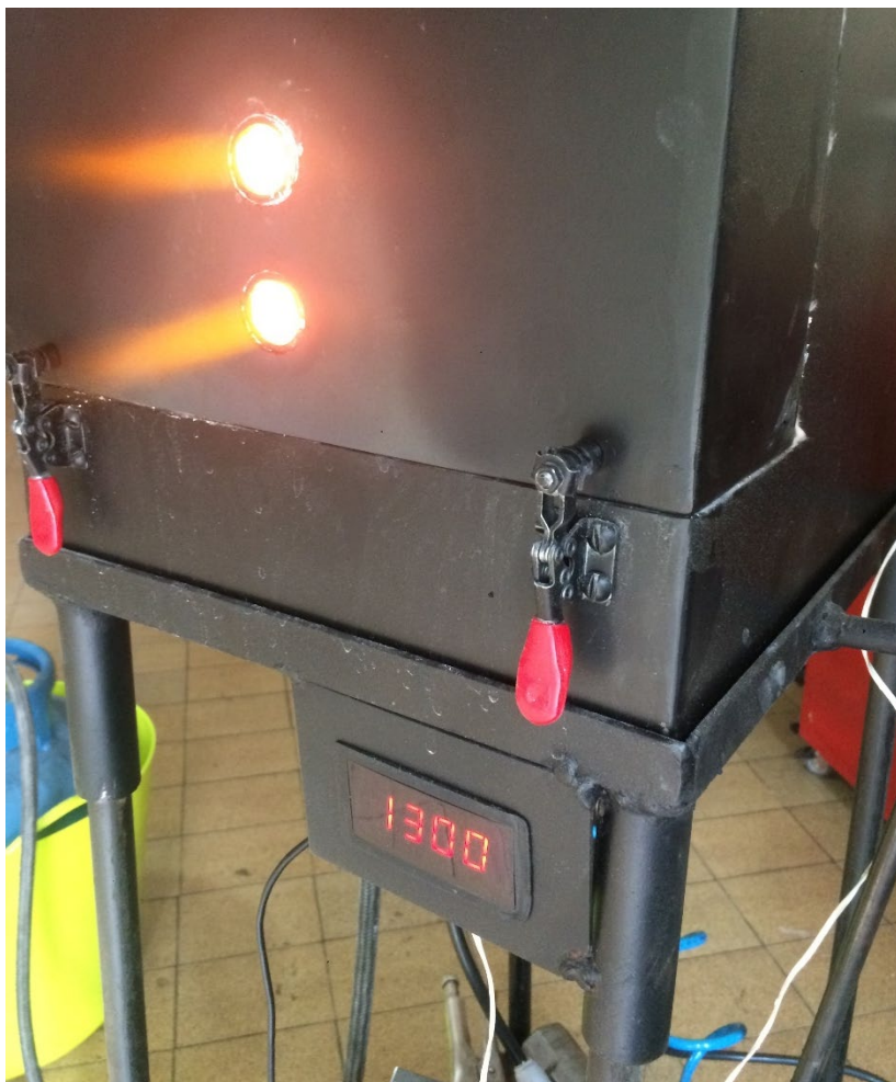
Figura 29: Temperatura final de aquecimento amostra 5.
