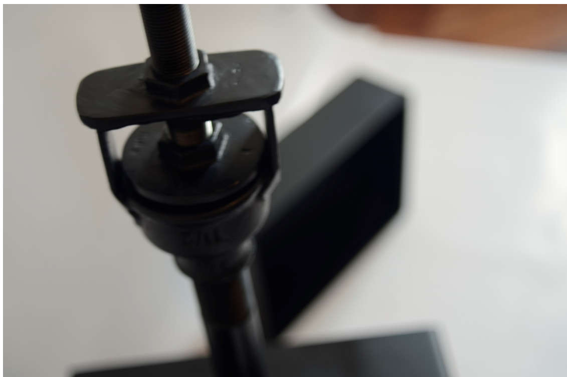
Figura 73: Misturador de gás e controle de ar do queimador.
