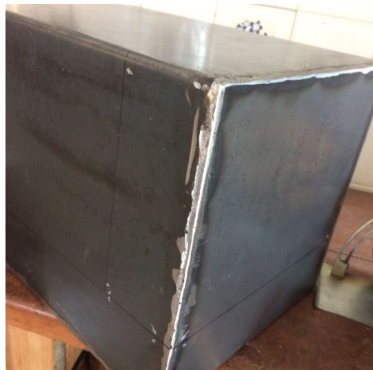
Figura 76: Marcação para corte das portas.
