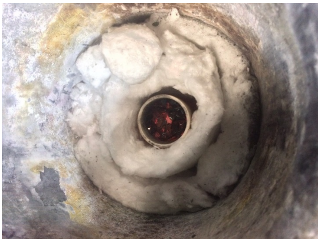
Figura 15: Início do aquecimento amostra 1 em forno de indução.
