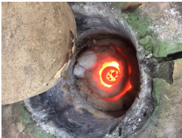
Figura 16: Aquecimento amostra 1 em forno de indução (Hall Tecnológico PMT)
