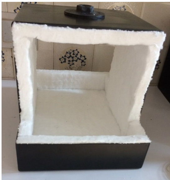
Figura 78: Isolamento de manta cerâmica instalada.
