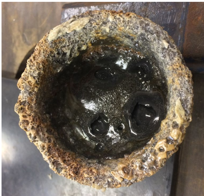
Figura 64: Inspeção do cadinho após resfriamento total.
