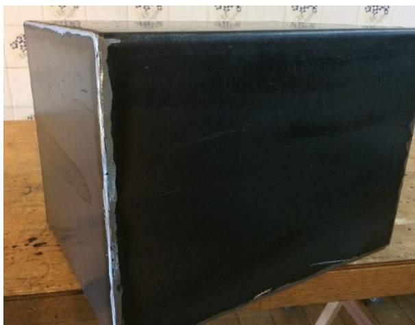
Figura 75: Carcaça do forno soldada.
