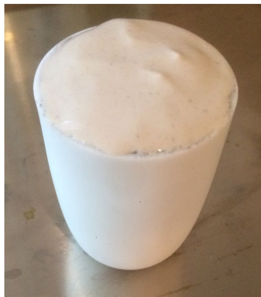
Figura 18: Cadinho selado com massa de alumina.
