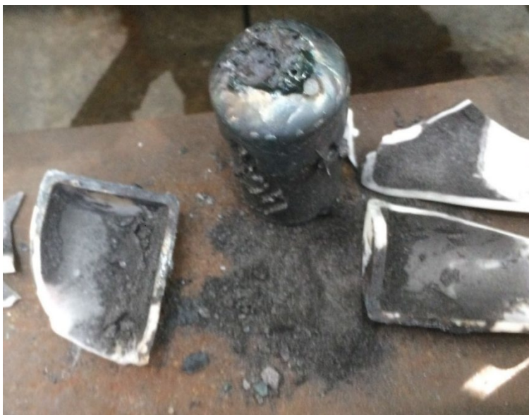
Figura 42: Experimento 1, grafite não se misturou.
