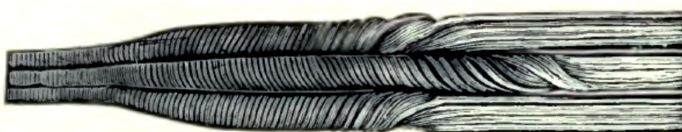
Figura 6: Cano de arma, barras retorcidas e conformadas em tiras(GREENER, 1910).
