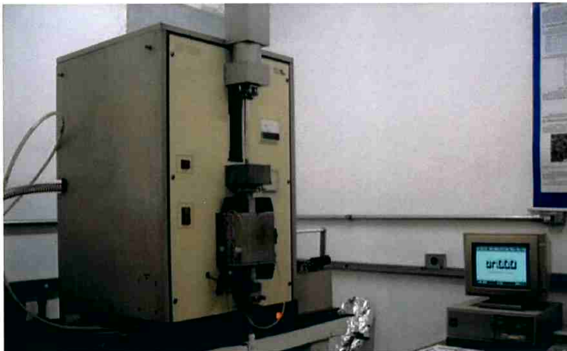
Figura 3.2 - Dilatômetro utilizado para o tratamento térmico dos corpos-de-prova. FONTE: (GONZÁLEZ-RAMÍREZ, 2012).
